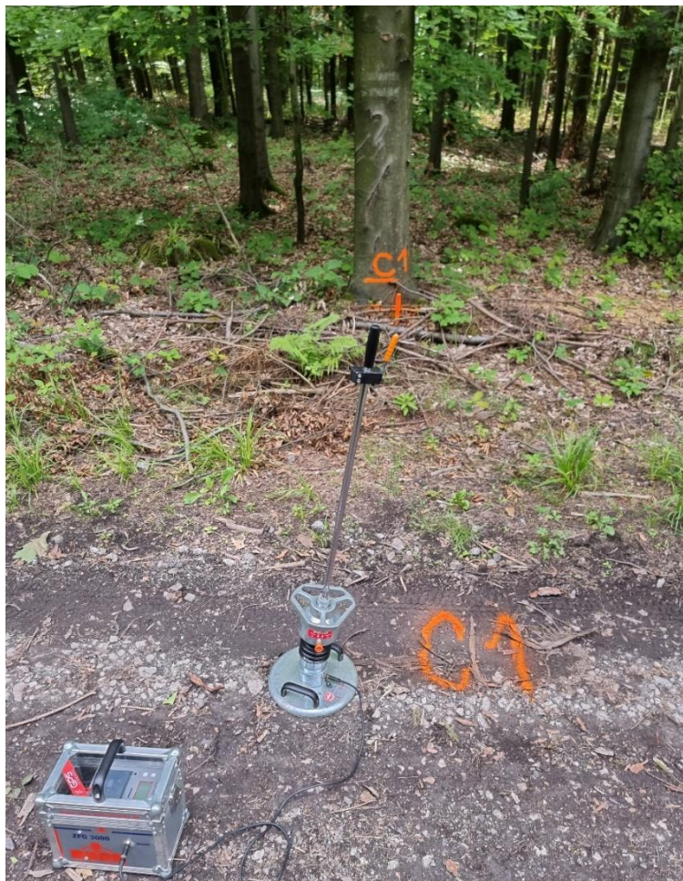
Obrázek 4 Lehká dynamická deska, zdroj: Adam Trefil
