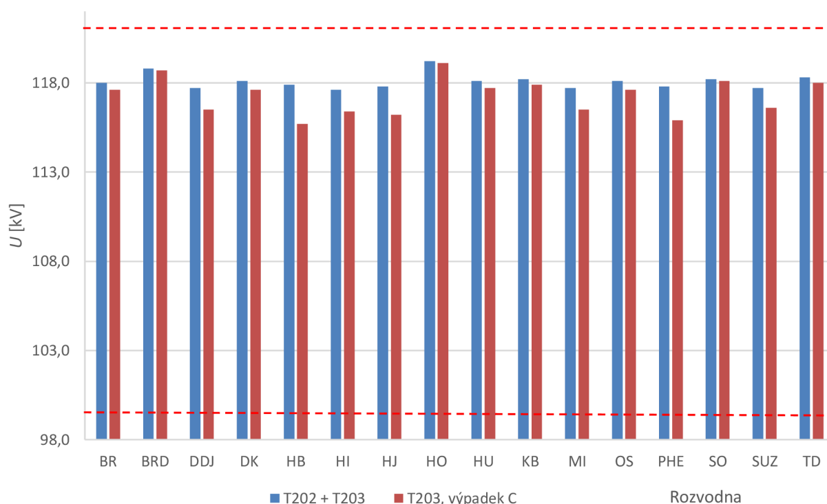
Obr. 8-5 Napěťové poměry, porovnání T202, T203 s T203 a výpadkem přípojnice C v SO
