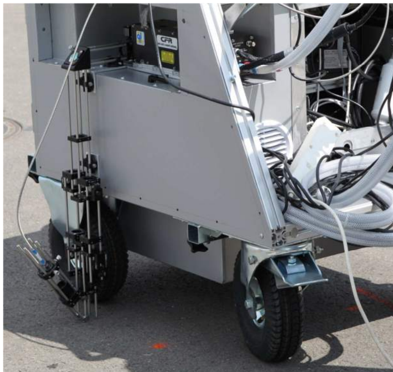
Obr. 22 rLIBS s modulem pro analýzu povrchu vozovky. V horní části obrázku je vidět umístění laserové hlavy a optika pro vyvedení laserového svazku kolmo k povrchu vozovky.
