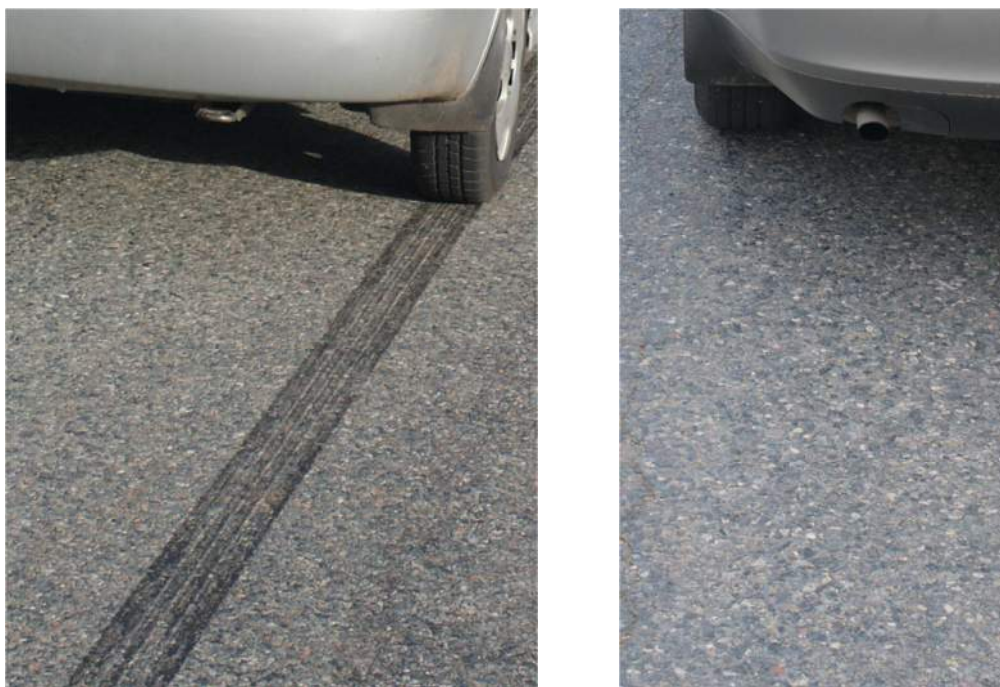
Obr. 6 Brzdné stopy automobilu, který není vybaven ABS (vlevo) a automobilu vybaveného ABS (vpravo). Oba automobily brzdily z rychlosti 58 \text{ km}\cdot\text{h}^{-1} maximální brzdovou silou.
