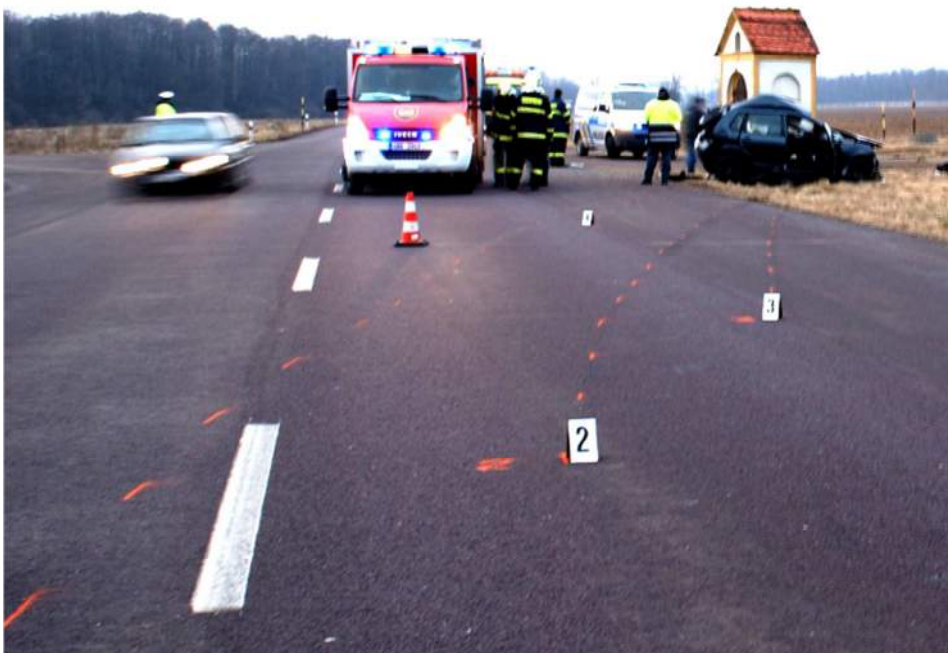
Obr. 1 Příklad vizuální identifikace brzdných stop a jejich označení pomocí spreje přímo na místě dopravní nehody.
