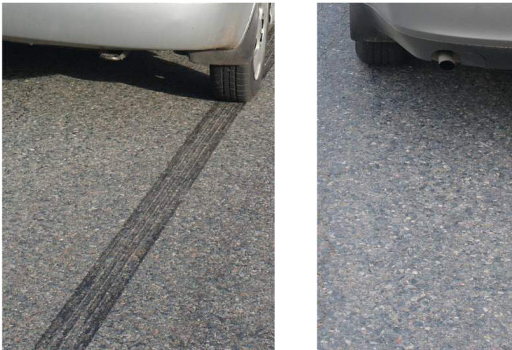
Obr. 6 Brzdné stopy automobilu, který není vybaven ABS (vlevo) a automobilu vybaveného ABS (vpravo). Oba automobily brzdily z rychlosti 58 \text{ km}\cdot\text{h}^{-1} maximální brzdou silou.
