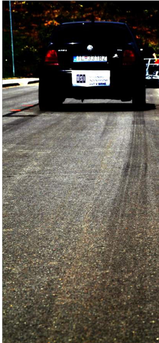
Obr. 43 Brzdná stopa vytvořená vozidlem Volkswagen Bora brzdícího maximálním brzdným účinkem z počáteční rychlosti 72 \text{ km}\cdot\text{h}^{-1} . Délka vzniklé brzdné stopy je 24,34 m a celková doba brzdění byla 2,72 s. Průběh zpomalení byl zaznamenán pomocí akcelerometru XL Meter™ 100. Fotografie je pořízena směrem od místa kde započalo brzdění ke konečné poloze automobilu.
