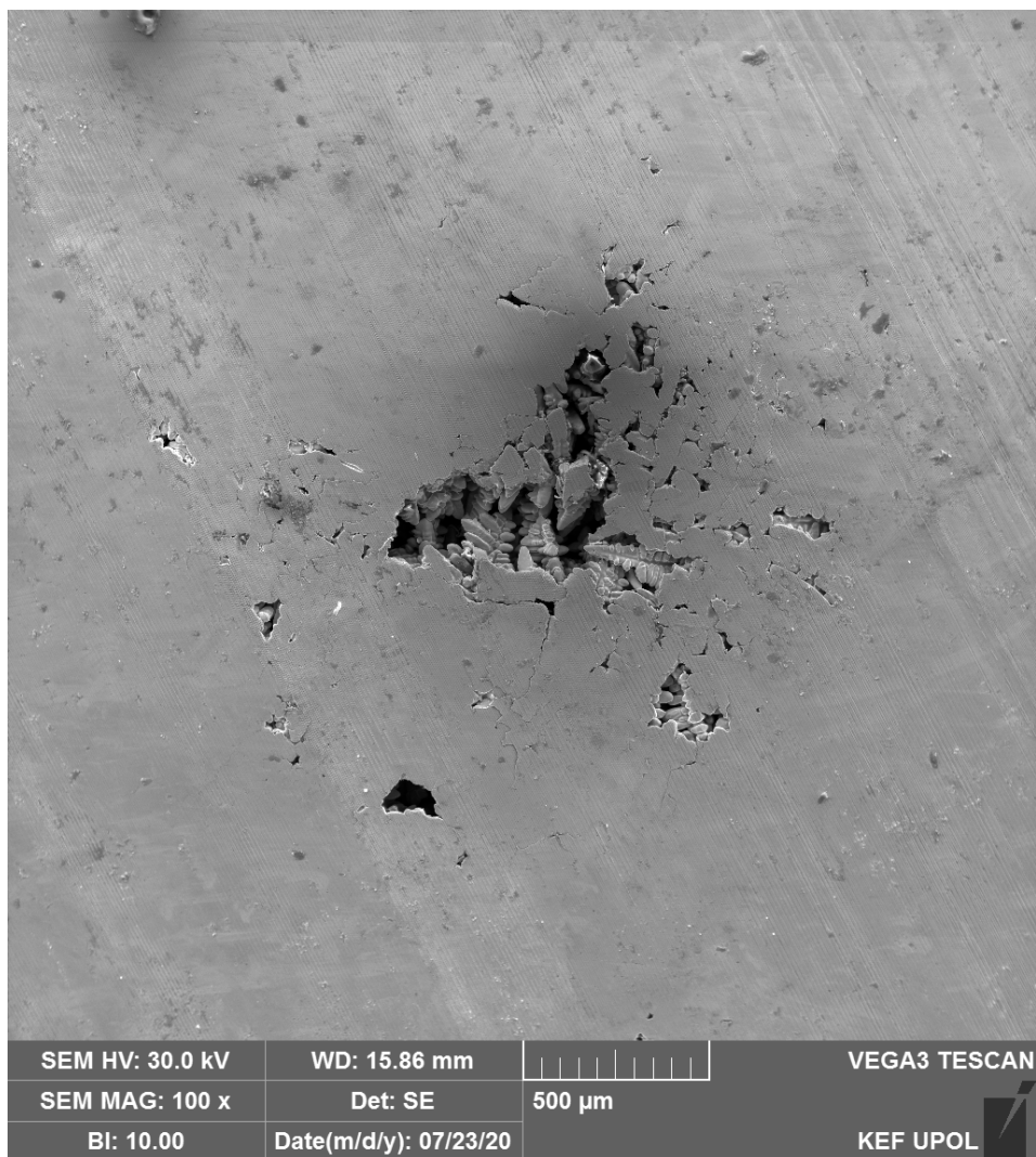
Obrázek 42 | Snímek pořízený ze SEM. Na tomto snímku vidíme povrch materiálu včetně trhliny.
