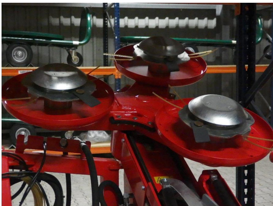
Obrázek 8 - Podsekávací ústrojí stroje Kneilmann Zaunkonig
