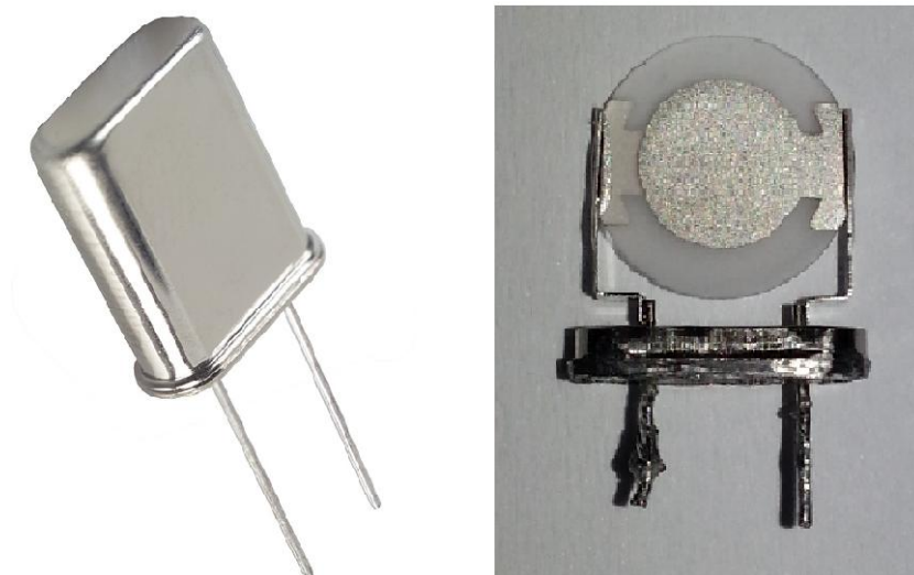
Obr. 7. Křemenný krystalový rezonátor: a) kovové pouzdro HC-49U b) pohled pod kryt
