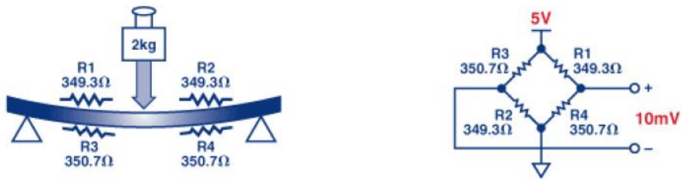
Obrázek 2: Princip a zapojení snímače hmotnosti [5]
