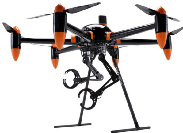
Obrázek 11: Konstrukční řešení ProDrone [10]
