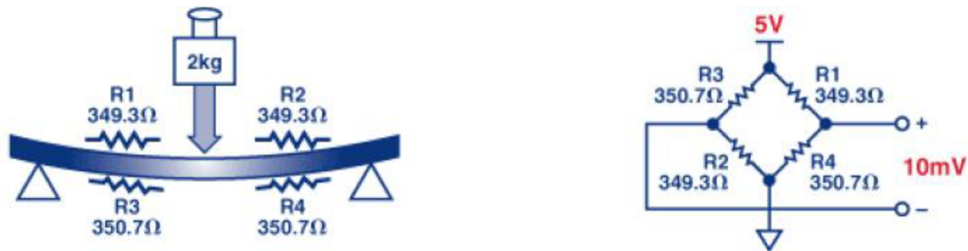
Obrázek 2: Princíp a zapojení snímače hmotnosti [5]
