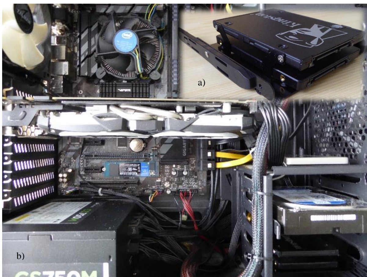
Obrázek 30: Umístění SSD disků do počítačové skříně a) připojení, b) náhled montáže do rámečku
