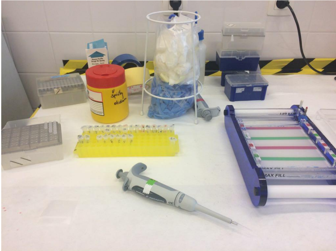
Obr. 10: Příprava vzorků na 1% agarózový gel (Jungová 2017)
