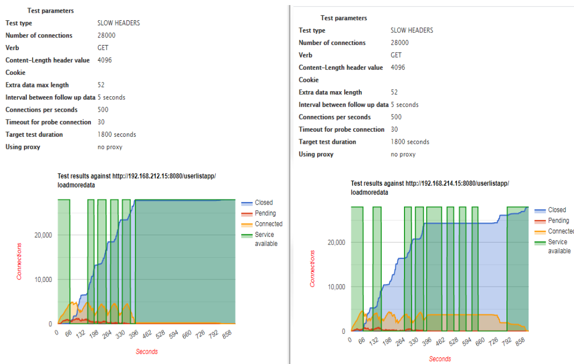
Obrázek 13 – Grafický výstup prvního testu SlowhttpTest aplikace z Kali Linux 01 desktopu.
