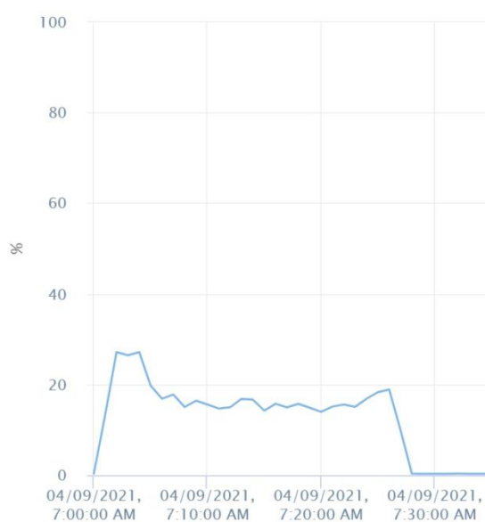
Obrázek 23 – Využití CPU Docker webserveru při třetím testu.
