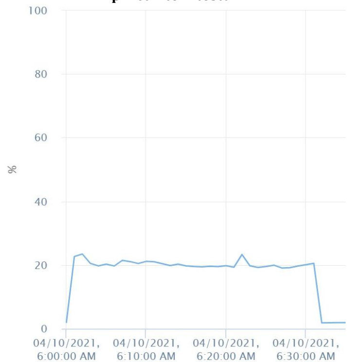
Obrázek 28 – Vytížení CPU webového serveru z kontejnerového prostředí při čtvrtém testu.
