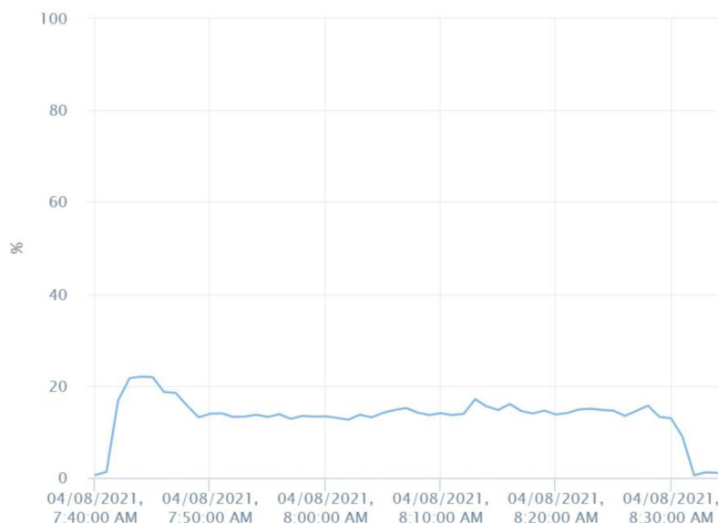
Obrázek 22 – Využití CPU Ubuntu webserver 1 při třetím testu.
