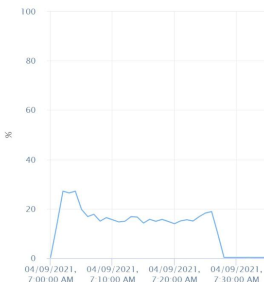
Obrázek 23 – Využití CPU Docker webserveru při třetím testu.
