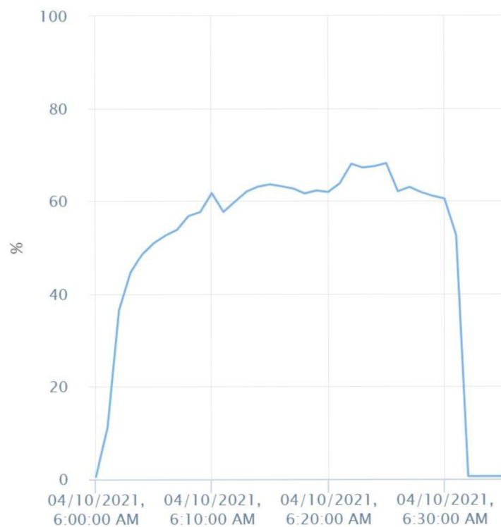
Obrázek 32 – Využití CPU load-balanceru v kontejnerovém prostředí při čtvrtém testu.
