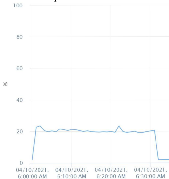
Obrázek 27 – Vytížení CPU z virtualizovaného prostředí Ubuntu webserver 1 při čtvrtém testu.
