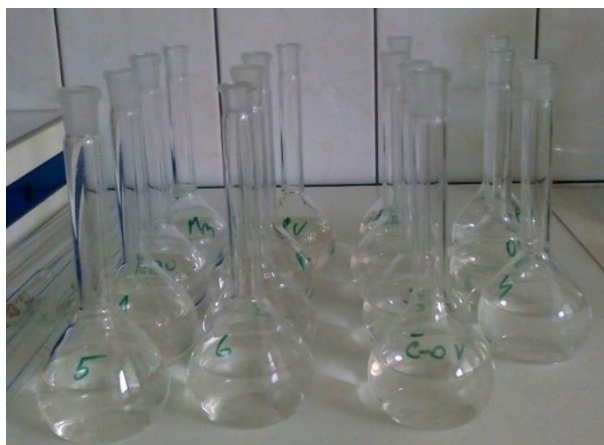
Obr. 3.7 Vzorky vody připravené k analýze koncentrace manganu po 1 hodině odstání
