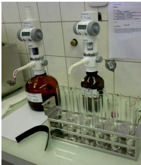
Obr. 3.2 Dávkováče šťavelanu sodného a manganistanu draselného
