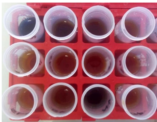
Obr. 3.3 Vzorčky vody s rozdílnými koncentracemi hliníku
