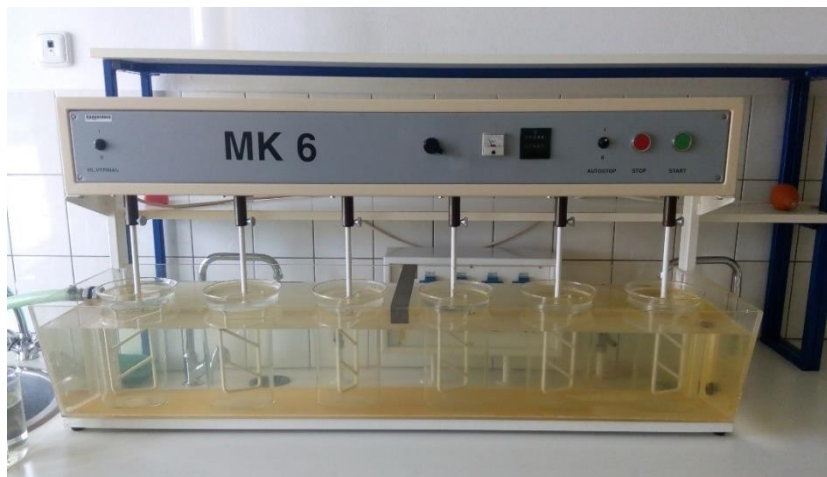
Obr. 2.1 Míchací kolona s koagulačními kádinkami
