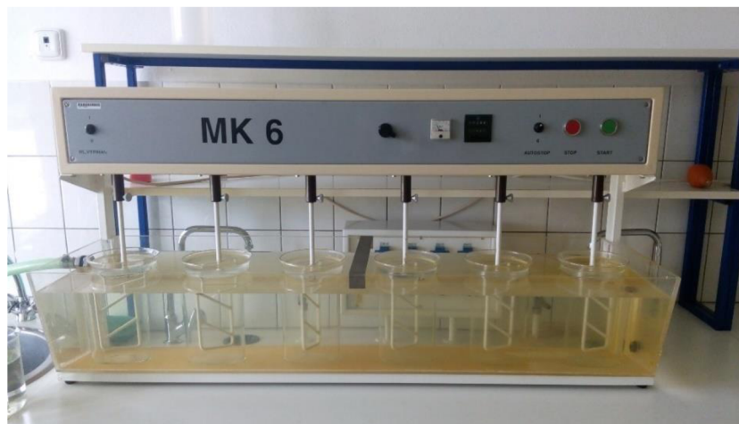
Obr. 2.1 Míchací kolona s koagulačními kádinkami
