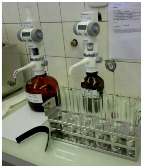
Obr. 3.2 Dávkovače šťavelanu sodného a manganistanu draselného
