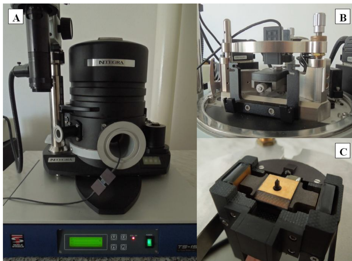
Obr. 39: A – Celkový pohľad na systém NTEGRA pri vykonávaní nanomechanických skúšok, B – Záber na hlavu TriboScope umiestnenú nad vzorkou na stolčeku, C – Detail na prevodník hlavy TriboScope (v strede je testovací hrot).
