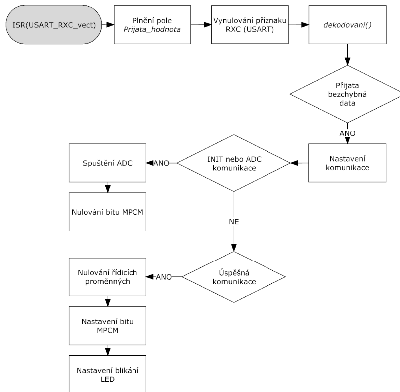
Obr. 4.10: Vývojový diagram obsluhy přerušení ISR(USART_RXC_vect)
