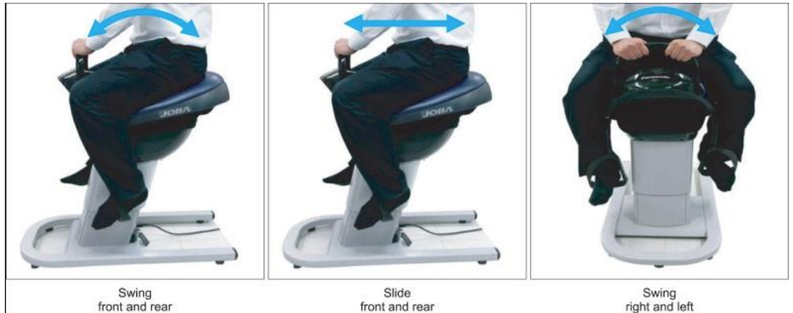
Obr. 8: Pohybový vzorec jezdeckého robotického simulátoru (Han et al. 2012)
