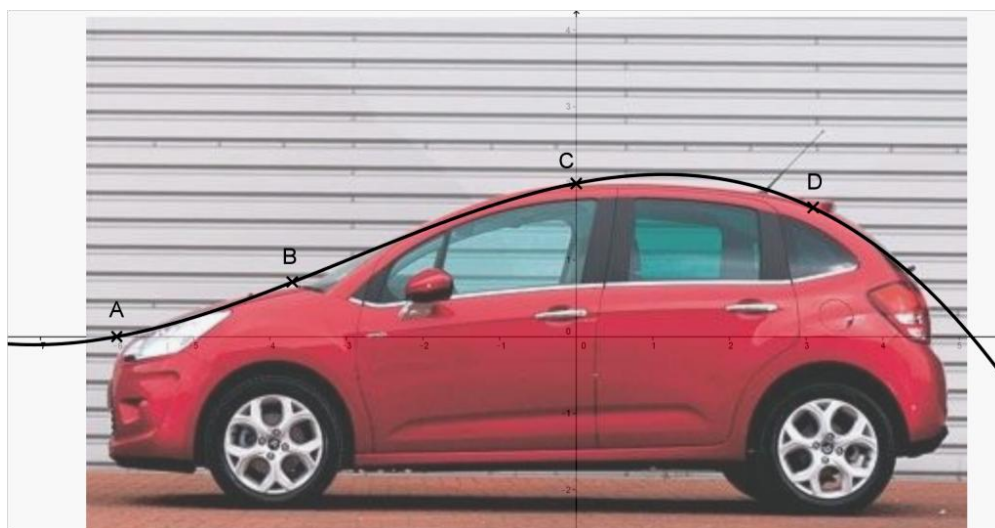
Obr. 23. Silueta automobilu proložená Lagrangeovým interpolačním polynomem 3. stupně. [11]
