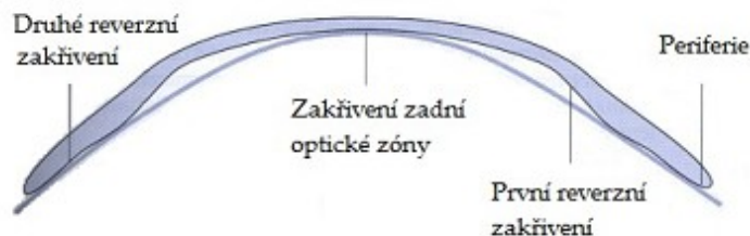
Obr. 13 – Reverzní kontaktní čočka druhé generace – pohled z boku [6]
