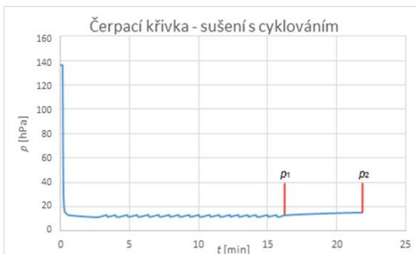
Obr. 24: Celkový náhled na průběh tlaku při sušení s pomocí cyklování, s nelineárním nárůstem tlaku \Delta p .
