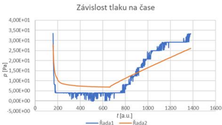
Obr. 16: Graf porovnání čidel. Schodovitý průběh čidla CTR 1000 (Řada 1) a CTR 100 (Řada 2) s hladkým a pro náš experiment vhodným průběhem.
