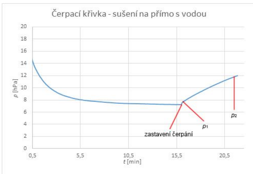
Obr. 21: Graf závislosti tlaku na čase při sušení na přímo s vlivem přidané vody ( \Delta p vykazuje nelineární, ale konstantní průběh nárůstu tlaku).
