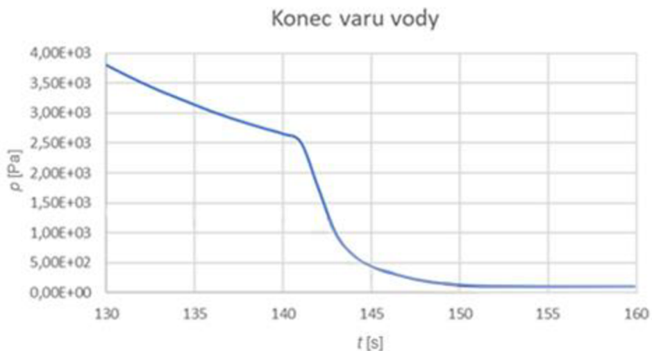
Obr. 15: Detail průběhu 4. poklesu z čerpací křivky viz Obr. 14.
