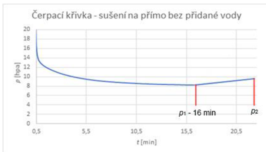
Obr. 20: Graf závislosti tlaku na čase při sušení na přímo bez přidané vody (lineární průběh \Delta p ).
