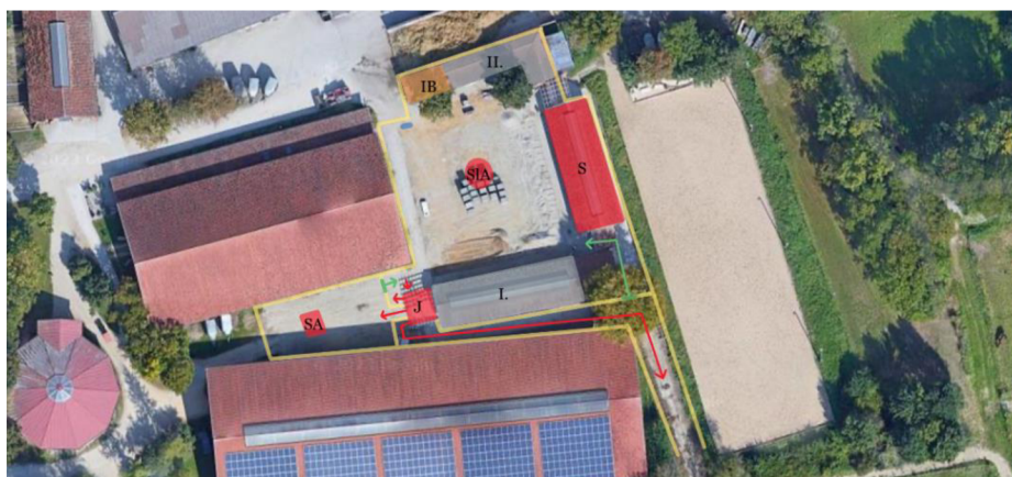
Obrázek 3.21 Boxová stáj přestavěná na aktivní (ze stájí byly vybudovány I, II – odpočívárny, IB – integrační box a S – časově kontrolovaný automat na seno, paddock tvoří bývalé nádvoří, kde se nachází napáječka, SIA – adlibitní krmíště slámy a J – automat na jádro s trojím odchodem – zpět do paddocku, na pastvu a k SA – adlibitnímu krmíšti sena (Google Maps, úprava autora, 2023)
