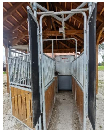
Obrázek 3.16 Pohled do krmného boxu au- tomatu objemných krmiv s viditelnou po- suvnou deskou (archiv autora, 2022)
