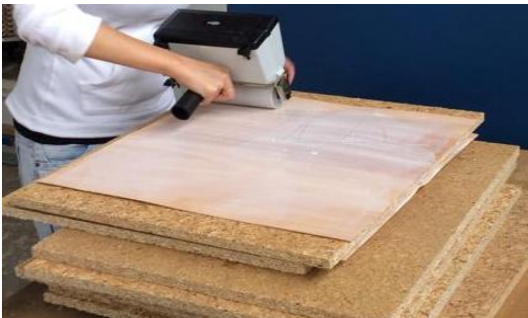
Obr. 11 – Ruční nanášení lepidla válečkovou nanášečkou
