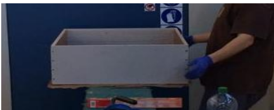
Obr. 10 – Formovací krabice pro dřevotřískové desky
