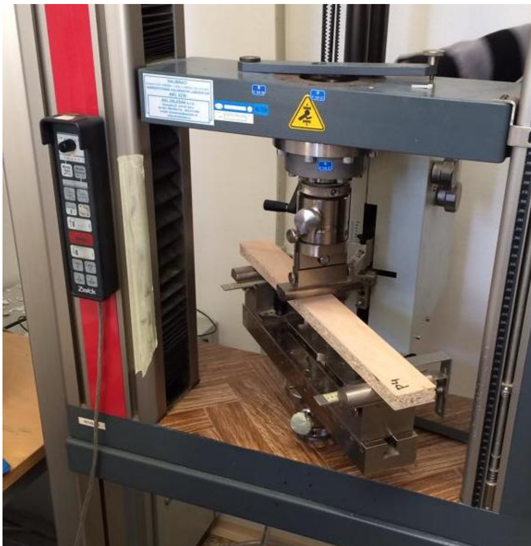
Obr. 15 - Stroj ZWICK z50 pro testování ohybu a tahové pevnosti
