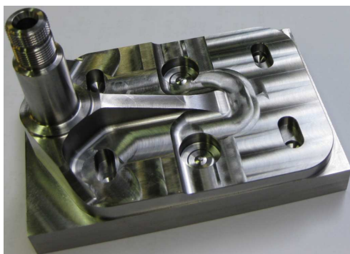
Obr. 4.3.6.3 Obrobek stávající výroby součásti po dokončení 1. strany (MCFV, Mazak) a před operací na konvenční frézce TOS Žebrák FNGJ20
