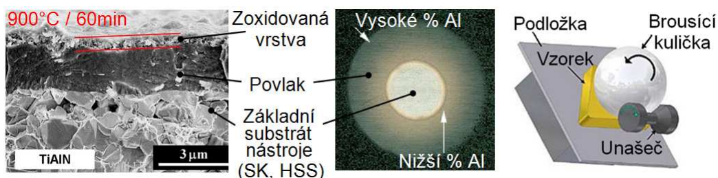
Obr. 2.4.6.2 Nanovrstevný gradientní povlak TiAlN - MARWIN G od firmy SHM 8,72
