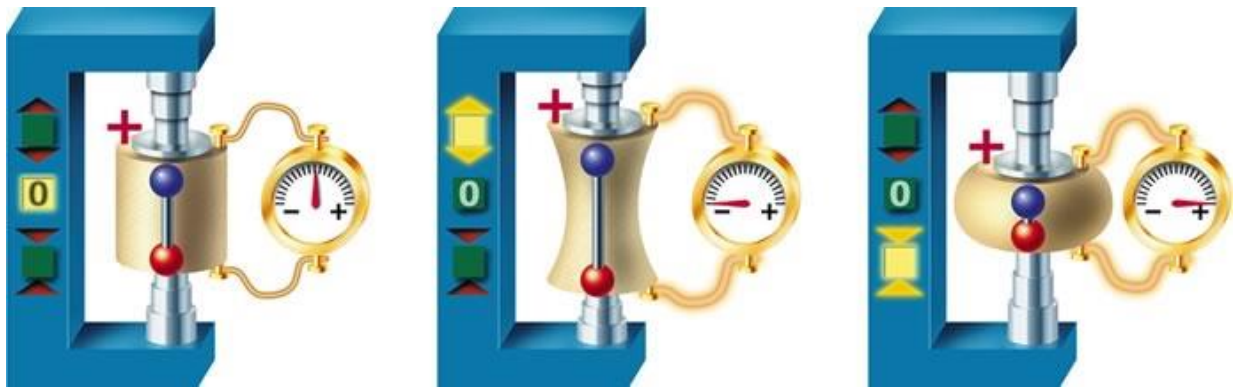
Obr. 8: Generování napětí pomocí piezoelektrického jevu [15]
