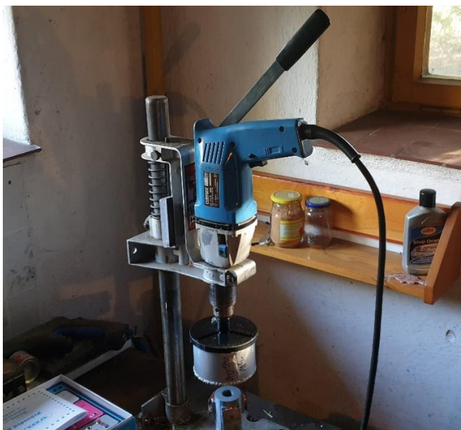
Obr. 18: Vrtačka ve stojanu (520 otáček za minutu)
