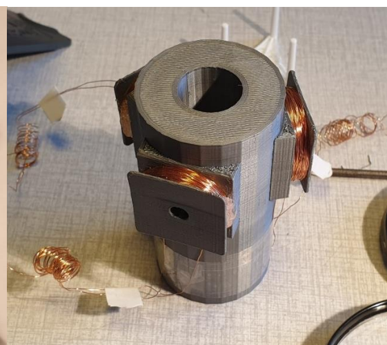
Obr. 22: Kostry s navinutými cívkami na hřídeli
