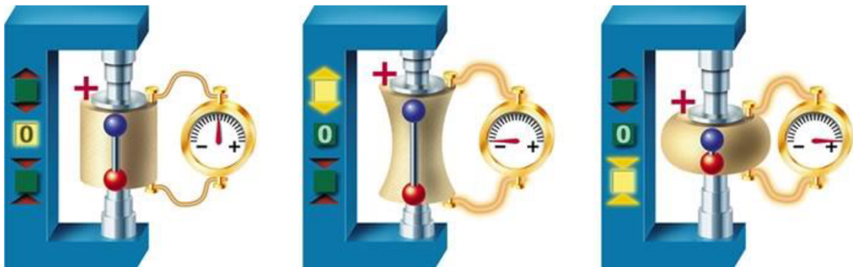
Obr. 8: Generování napětí pomocí piezoelektrického jevu [15]
