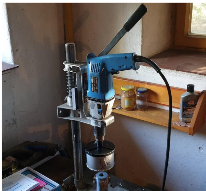
Obr. 18: Vrtačka ve stojanu (520 otáček za minutu)
