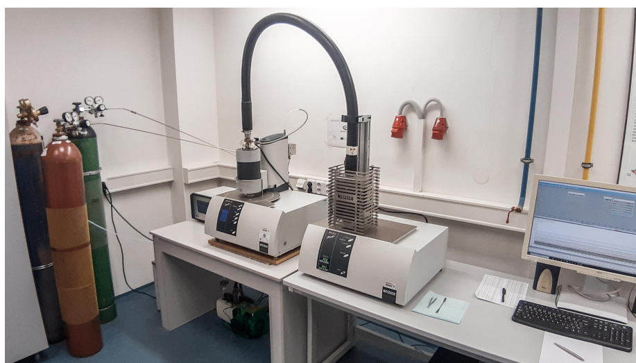
Obrázek 6.3: Ukázka zapojení termogravimetrického analyzátoru a kvadrupólového hmotnostního spektrometru (QMS) pomocí vyhřívané spojky a trubice. Vlevo jsou tlakové nádoby s dusíkem a kyslíkem pro vytvoření plynné atmosféry při TGA.
