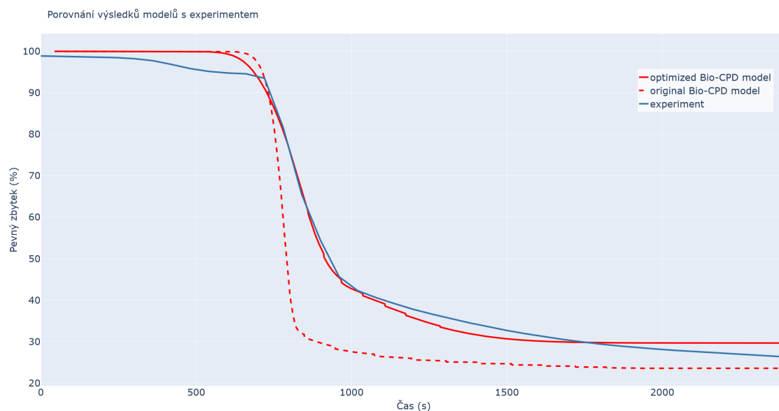
Obrázek 6.14: Porovnání úbytku hmotnosti experimentálního vzorku hemicelulózy (modrá plná čára) a modelu Bio-CPD s původními kinetickými parametry (přerušovaná červená čára) a optimalizovanými parametry (plná červená čára).
