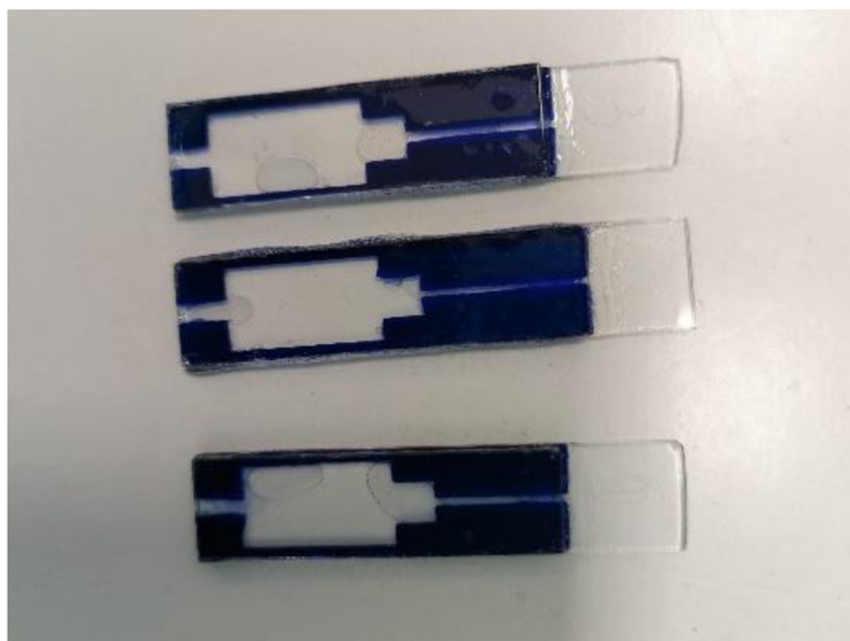
Obrázek 15: Znárodná kontaminace roztoku chinin sulfát hydrátu v modifikované platformě OECT rozpuštěním částí vytvrzené fotorezistní fólie, která formuje měřicí prostor na platformě, kontaminace nastala při procesu lepení
