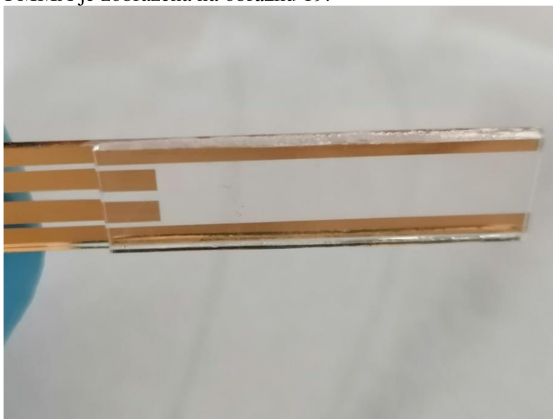
Obrázek 19: Test kvality připraveného lepidla PMMA o hmotnostní koncentraci 121,2 mg/ml, rozpuštěného v DCM
