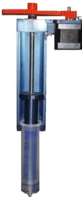
obr. 5-1 MarVtec Chocolate Extruder – usazení motoru [27]
