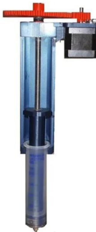
obr. 5-1 MarVtec Chocolate Extruder – usazení motoru [27]
