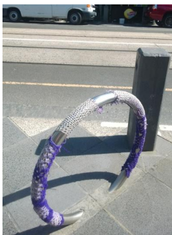
Obrázek 20. Příklad vyhovujícího stojanu typu „ring“ s bavlněným ochranným návlekm v Melbourne (autor)
