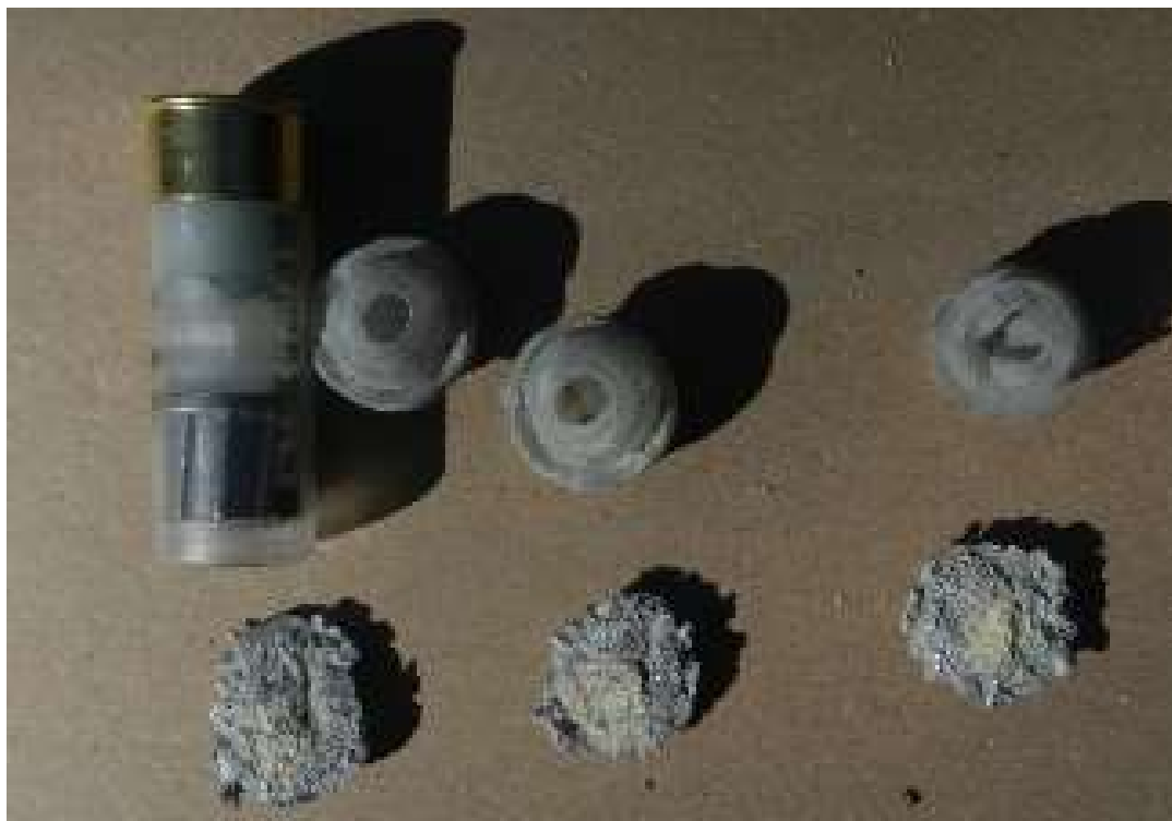
Obrázek 35 Porovnání nevystřeleného náboje a deformovaných střel s plastovými ucpávkami Foto: Přemysl Šedivka
