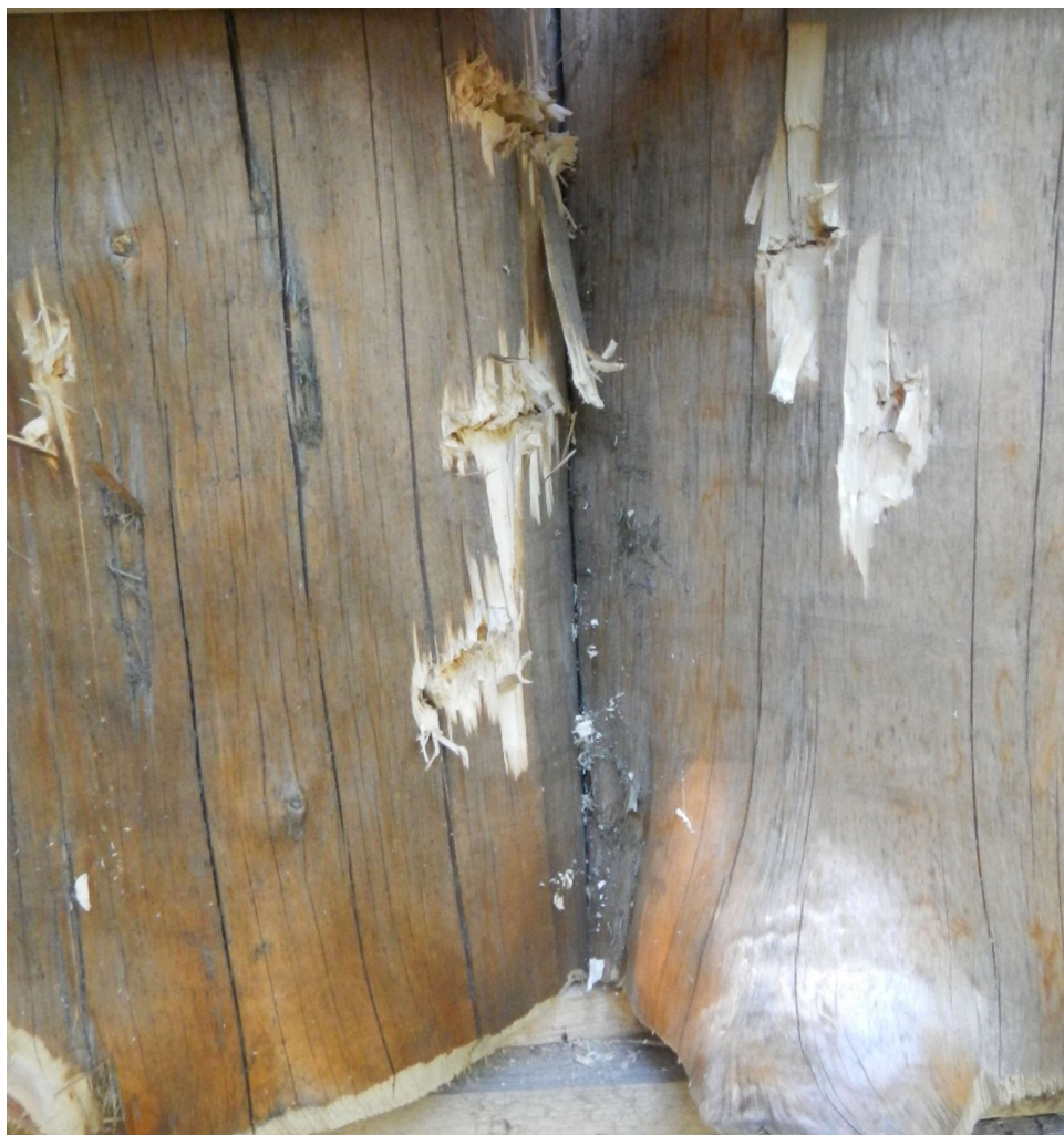
Obrázek 51 Skladba č. 4 TBO 7 CZ zadní strana vzorku s patrnými výtržemi dřevních vláken Foto: autor
