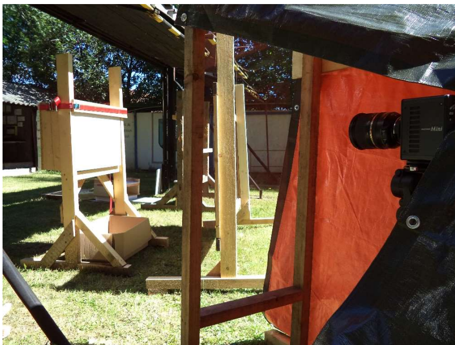
Obrázek 29 Pohled zezadu na vzorek uchycený v rámu s vysokorychlostní kamerou za ochranným plexisklem. Foto: Přemysl Šedivka
