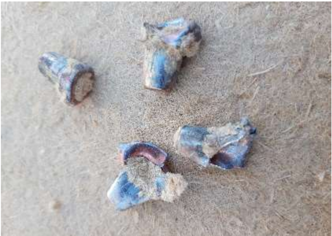
Obrázek 49 Skladba č. 3.3 TBO 7 CZ pláště střel zastavené ve vrstvě dřevovláknité izolace Foto: autor
