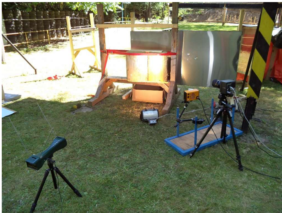
Obrázek 28 Zkoušecí sestava s vysokorychlostní kamerou pohled zpredu. Foto: Přemysl Šedivka
