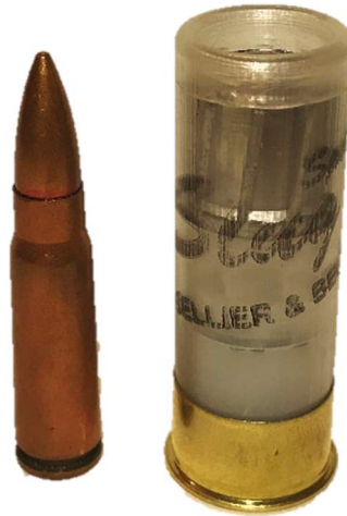
Obrázek 14 Použité brokové střelivo v porovnání s kulovým nábojem 7,62x39. Foto: autor
