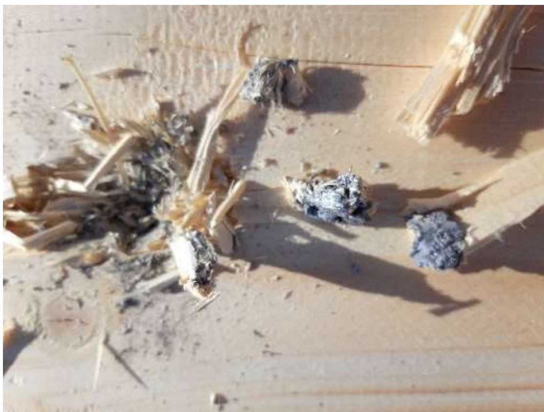
Obrázek 47 Skladba č. 3.3 TBO 6 značně deformované střely extrahované z vrstvy Dekpanelu Foto: autor
