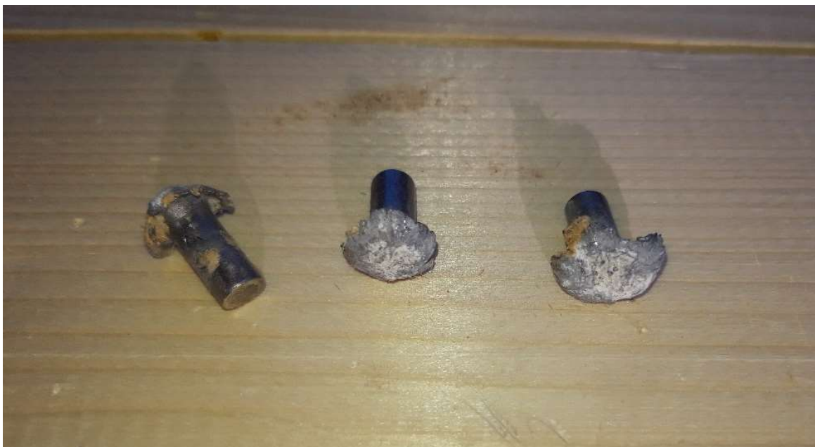
Obrázek 45 Skladba 3.3 TBO 5 CZ jádra střel deformovaná o vrstvu keramické a betonové dlažby Foto: autor
