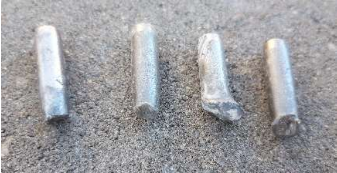
Obrázek 48 Skladba č. 3.3 TBO 7 CZ deformované jádra střel extrahované z vrstvy Dekpanelu Foto: autor
