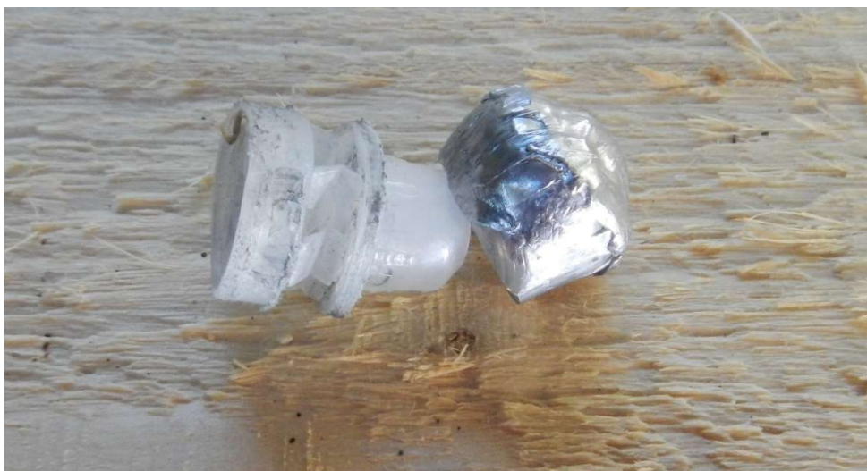
Obrázek 52 Skladba č. 4 TBO SG střela s plastovou zátkou zdeformovaná průchodem přes spoj sрубů Foto: autor
