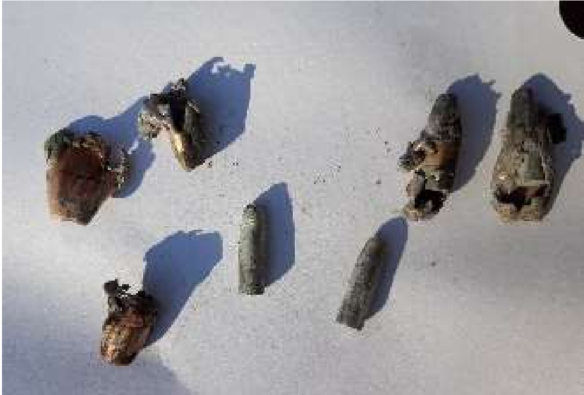
Obrázek 33 Skladba č. 1.2 TBO 5 CZ střely extrahované z vrstvy betonu Foto: autor
