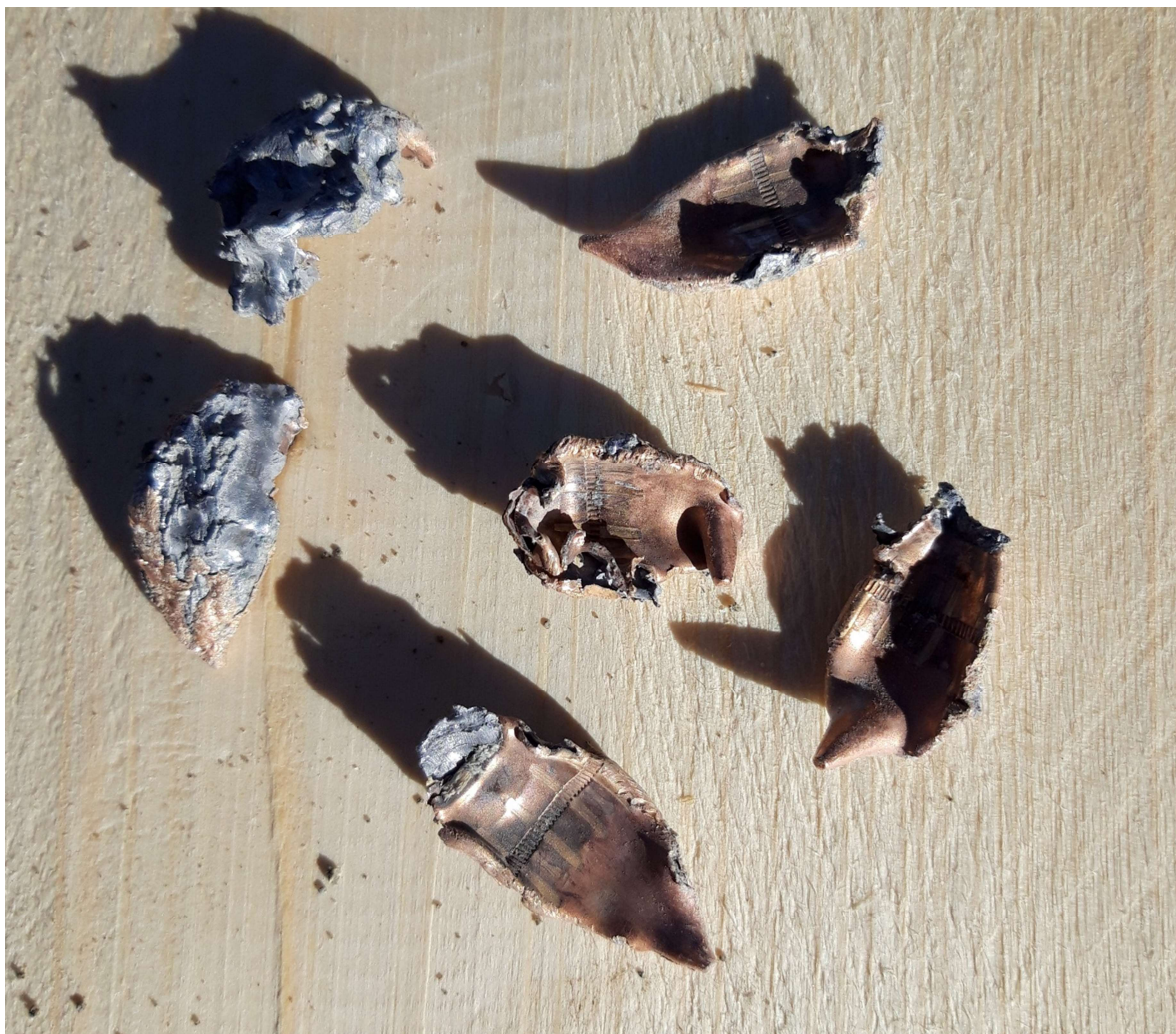
Obrázek 44 Skladba č. 3.1 TBO 6 deformované střely extrahované z vrstvy betonu Foto: autor
