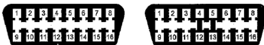
Obr. 7 EOBD 2 konektor pro palubní napětí 12 V a 24 V [9]
