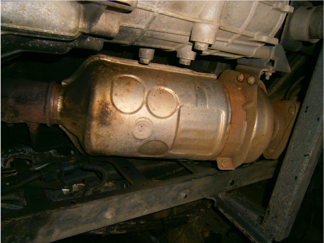
Filtr pevných částic Iveco Daily Stratos
