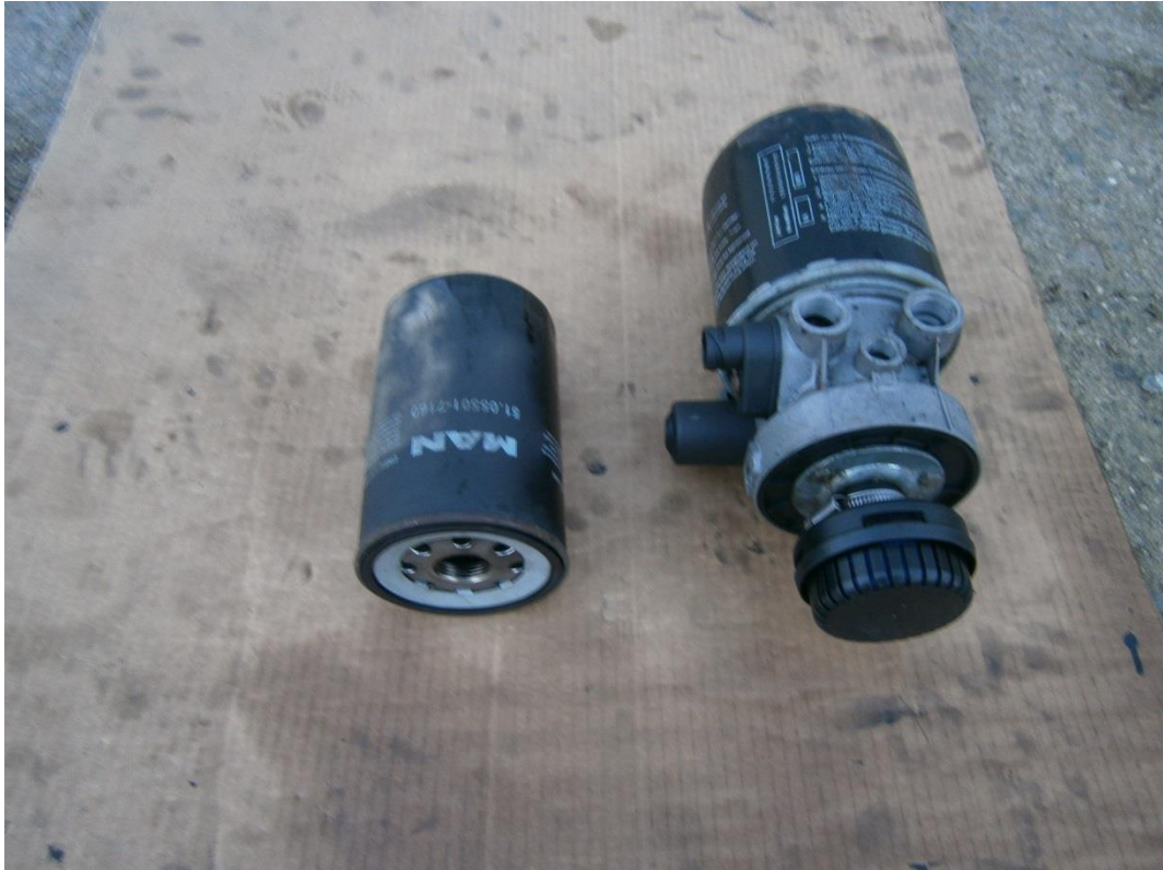
(vlevo) olejový filtr (vpravo) vysoušeč vzduchu vozidla Man TGX 18.440
