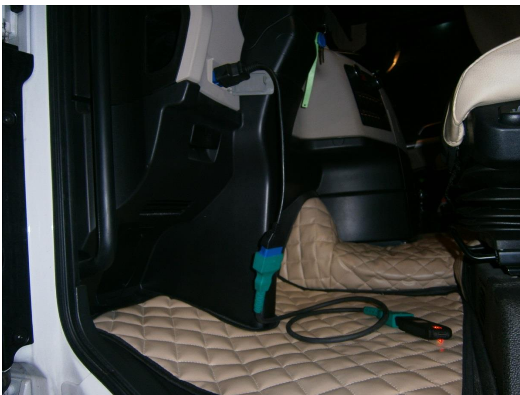
Připojení diagnostického přístroje Man-cats III ve vozidle
