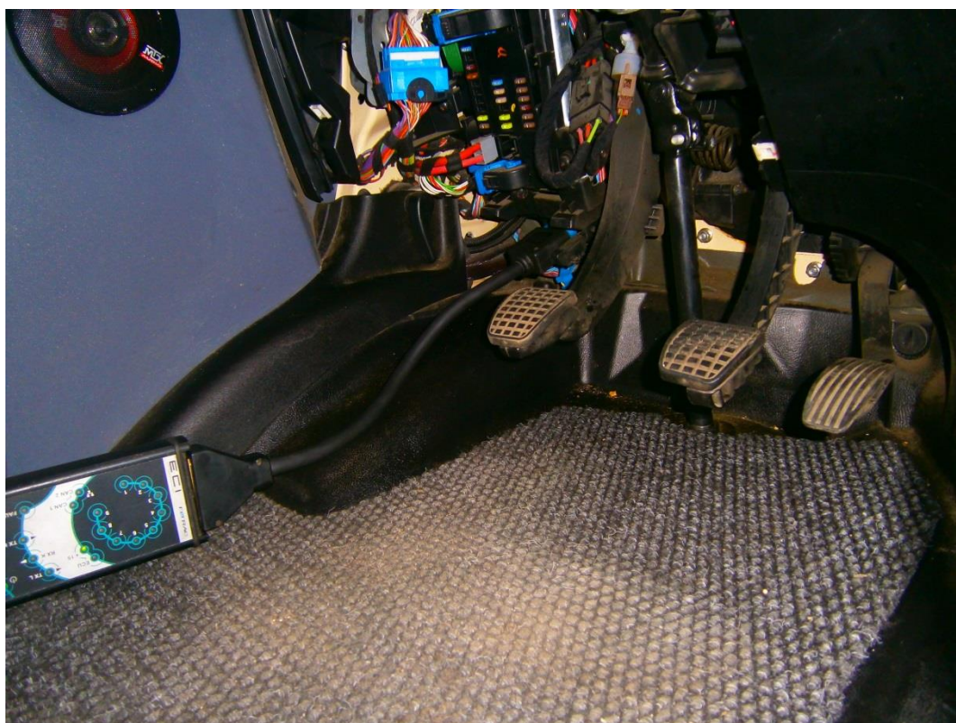
Připojení diagnostického přístroje k OBD konektoru
