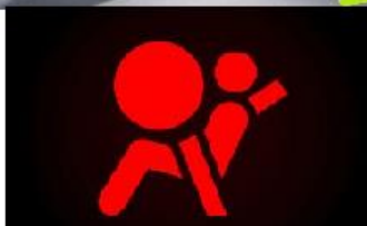
Signalizace závady airbagu palubním systémem
