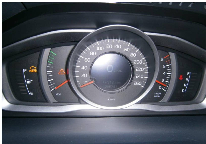
Obr. 24 Identifikace závady kontrolkou MIL Volvo V60 [ 27 ]
