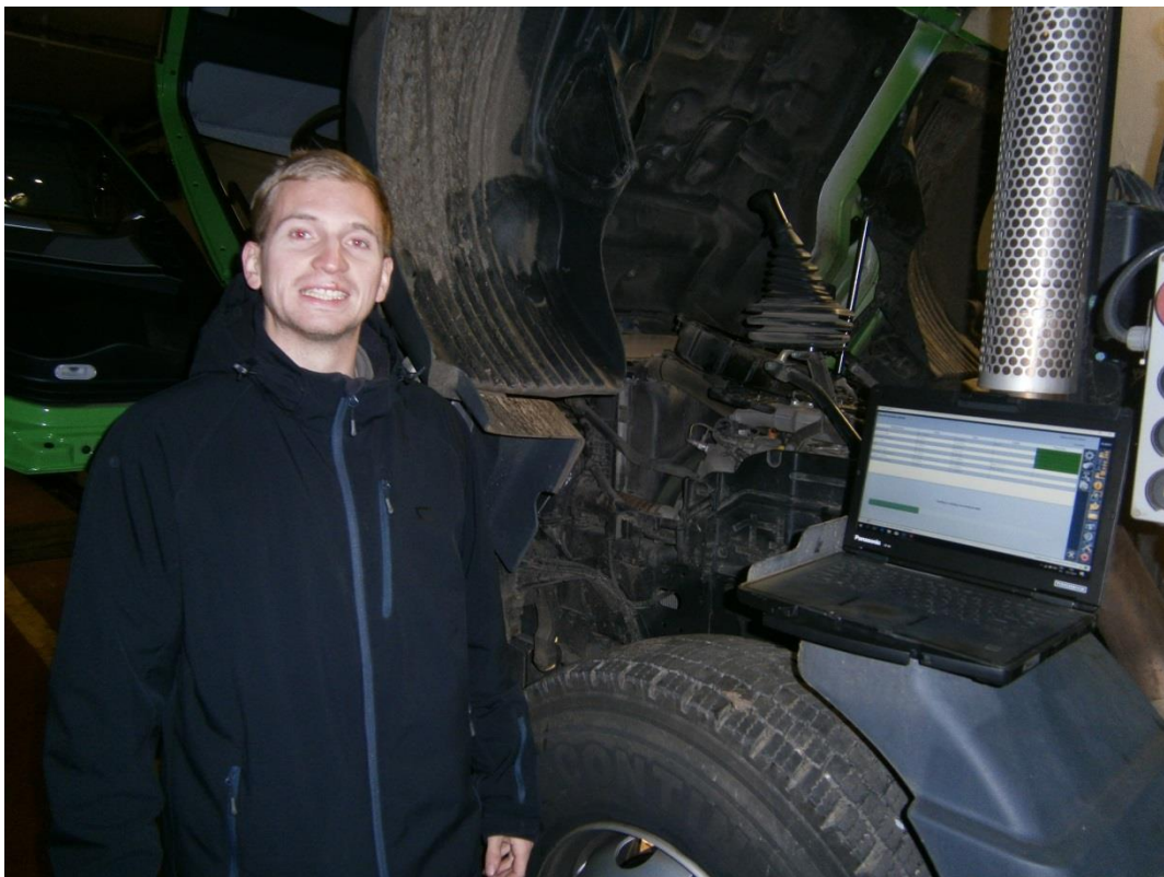
Použití diagnostického přístroje Man Cats III
