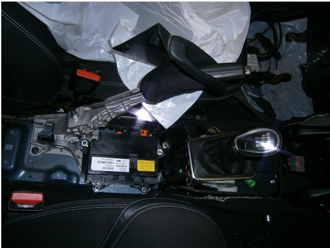
Umístění řídicí jednotky v interiéru vozidla
