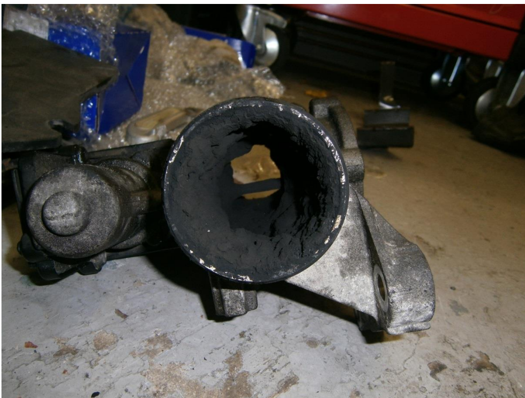
Zanesený EGR ventil
