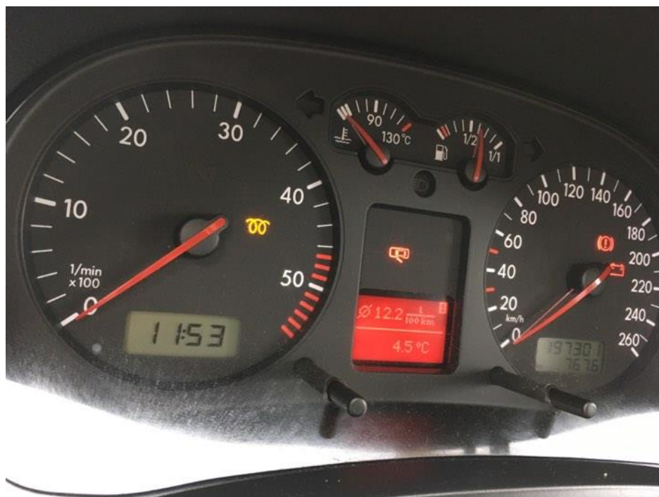
Signalizace závady palubním systémem
