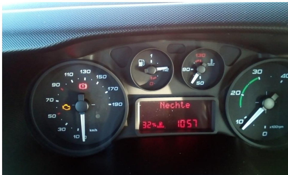
Obr. 31 Identifikace závady Iveco Daily stratos [27]
