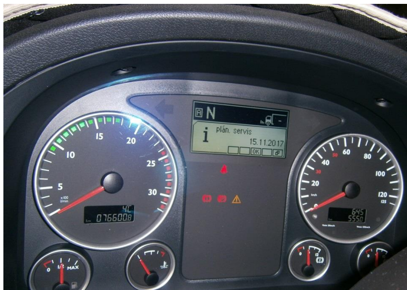
Obr. 36 Signalizace plánovaného servisu [27]
