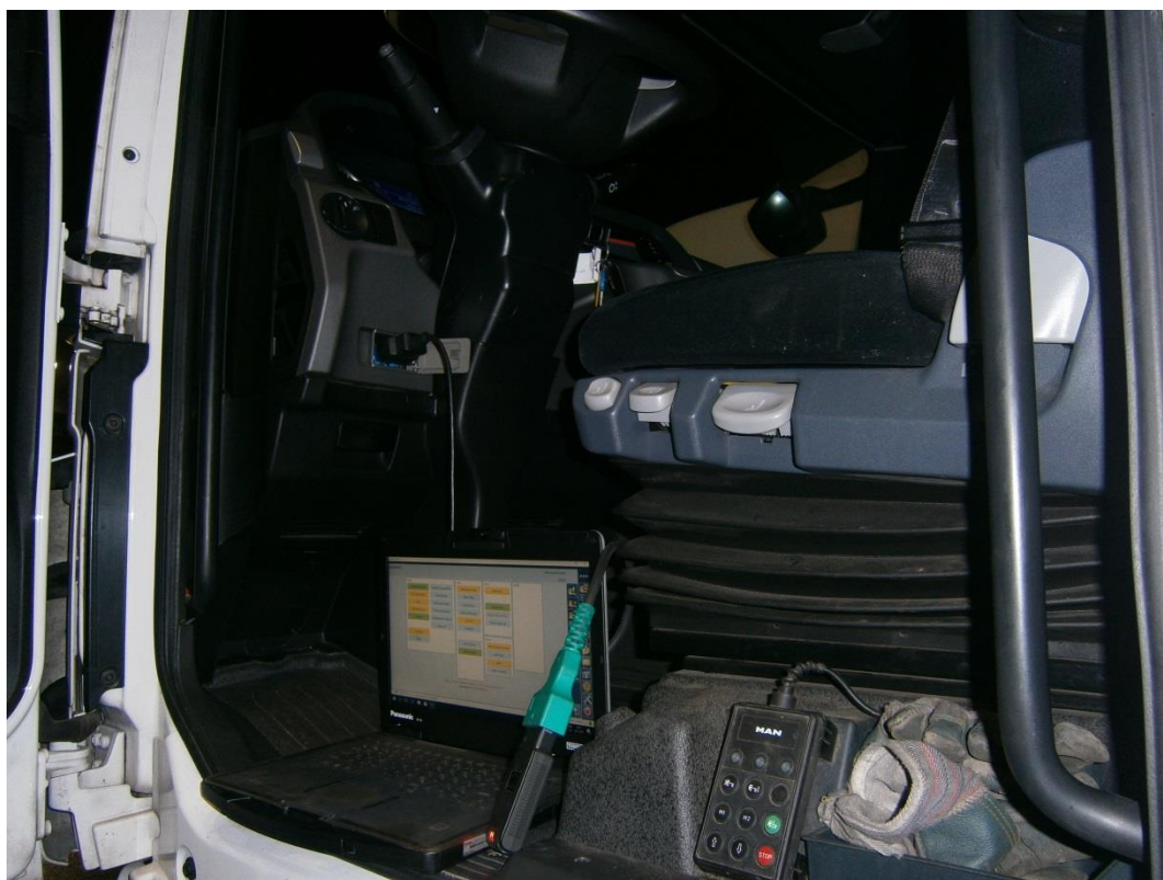
Použití diagnostického přístroje ke zjištění údržby vozidla
