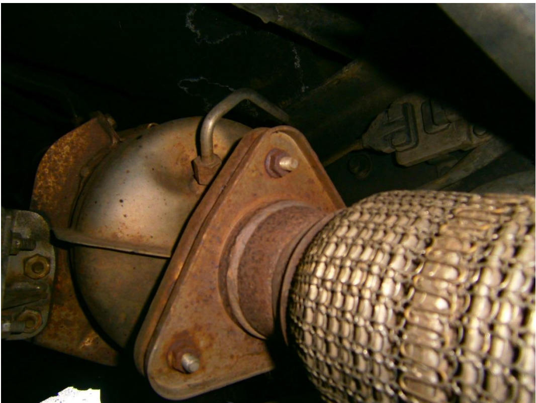
Filtr pevných částic Iveco Daily Stratos
