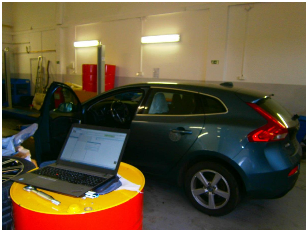
Zjišťování závady diagnostickým systémem Volvo VIDA
