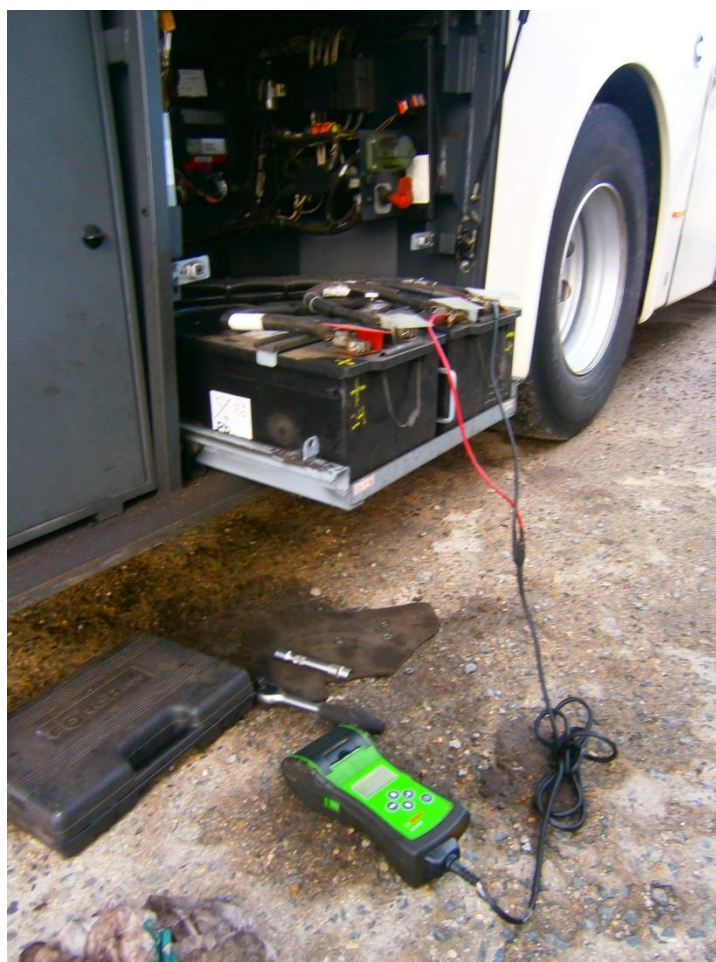
Připojení Bosch BAT 131 k akumulátoru 12 V
