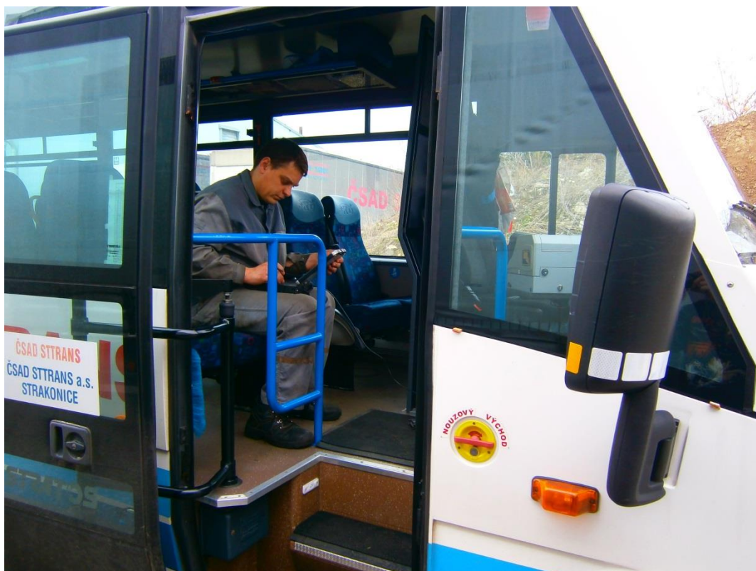
Zjišťování závady diagnostickým systémem Iveco Eltrac
