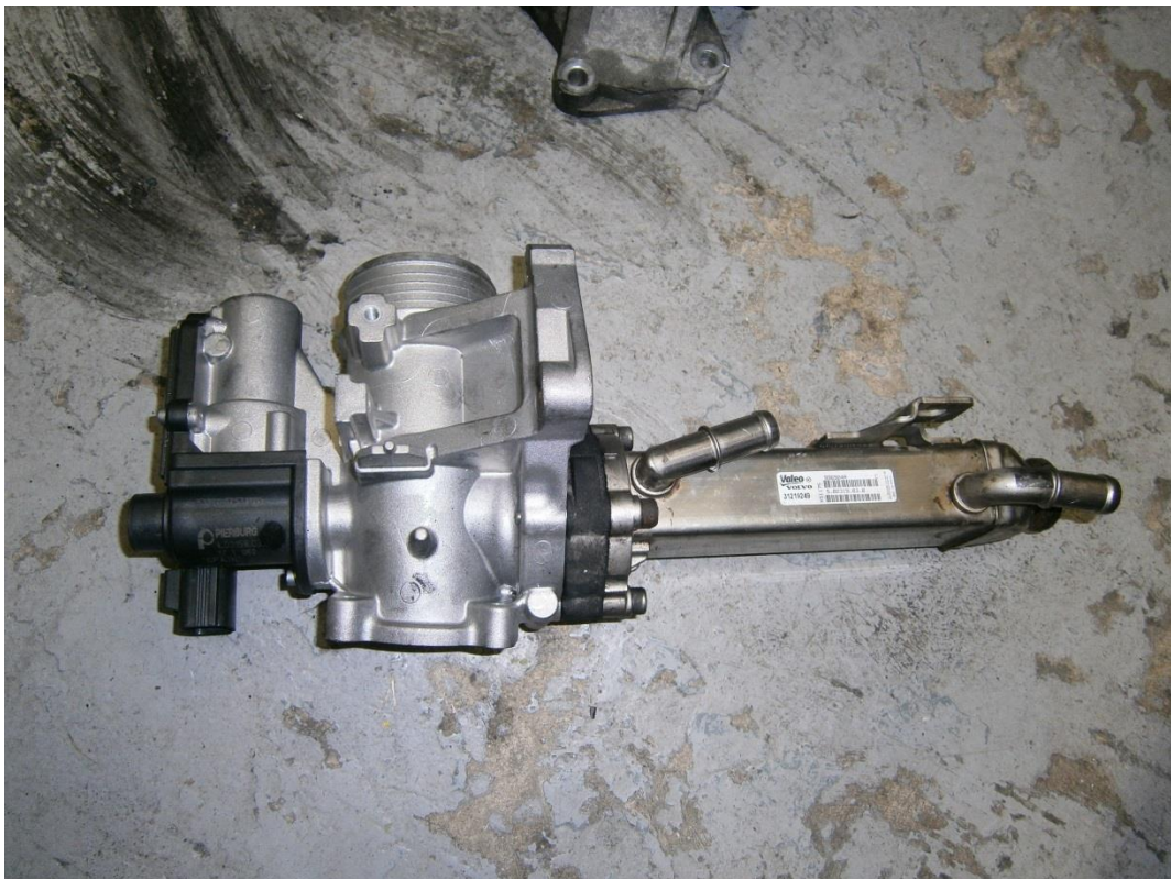
Nový EGR ventil s chladičem
