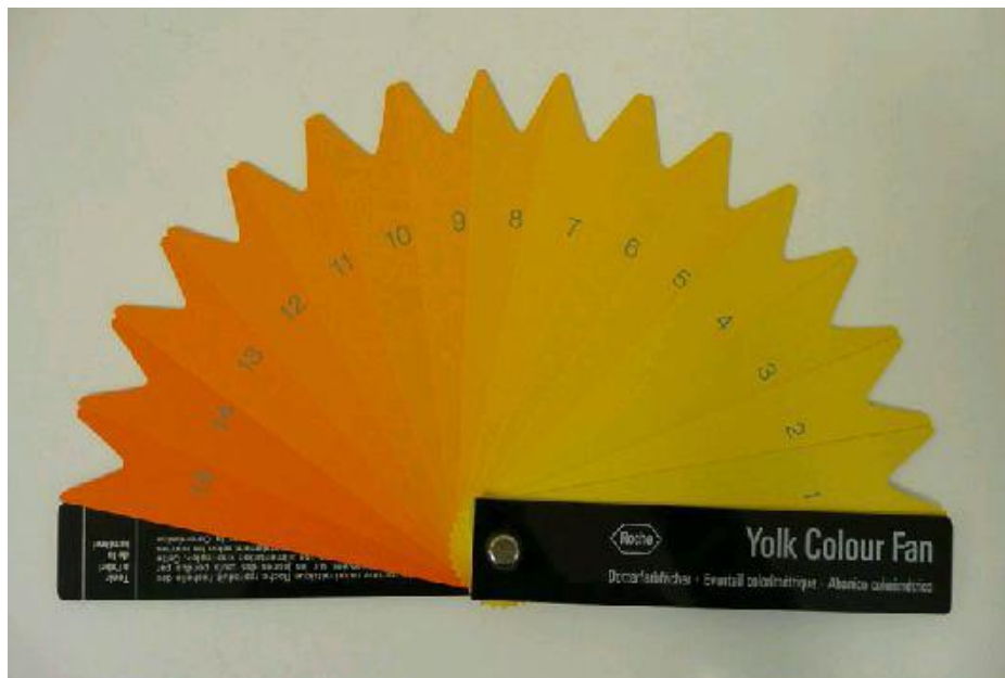
Obr. 1 Stupnice La Roche pro určení barvy žloutku (Poultry Hub, 2012).
