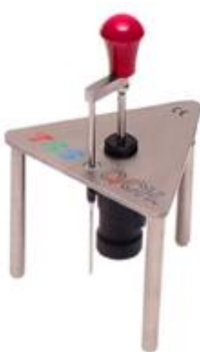
Obr. 5 QCH – přístroj pro stanovení výšky bílku, výšky žloutku a Haughovy jednotky (TSS York, UK)
