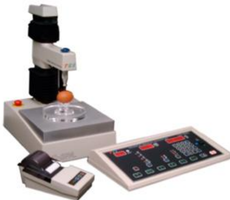
Obr. 2 Large spa – přístroj pro stanovení pevnosti skořápky (TSS York, UK)
