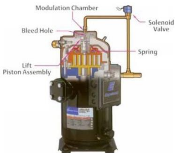
Obrázek 1.5.1.4 Digital Scroll kompresor [5]
