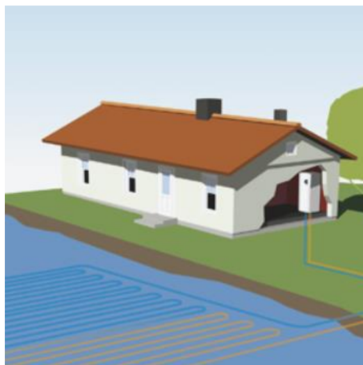
Obrázek 1.4.1.2 Tepelné čerpadlo voda – voda (vodní plocha) [3]
