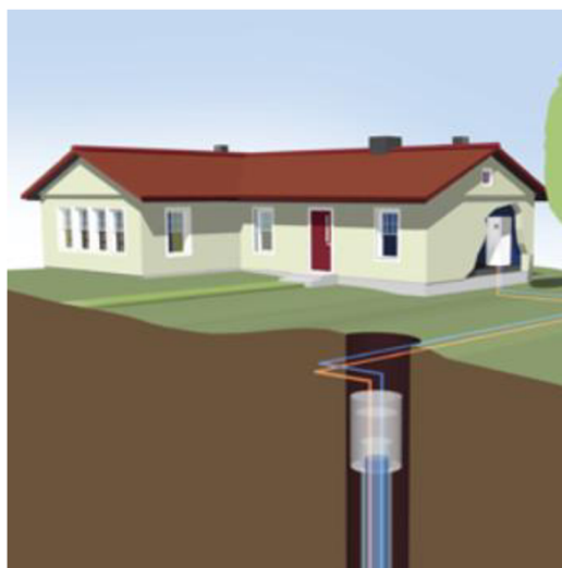
Obrázek 1.4.2.1 Tepelné čerpadlo země-voda (zemní vrt) [3]
