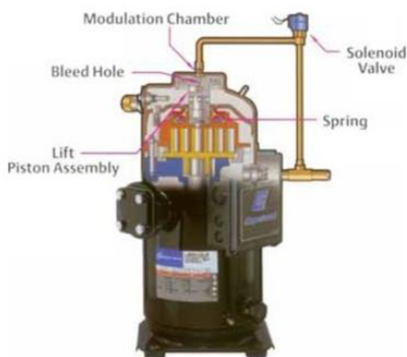
Obrázek 1.5.1.4 Digital Scroll kompresor [5]
