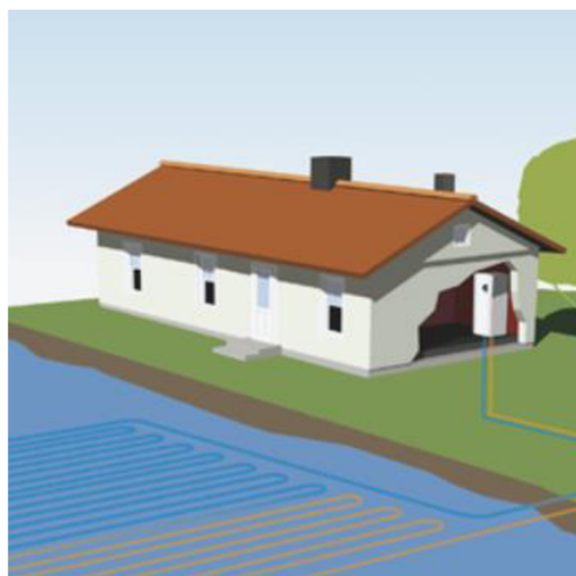
Obrázek 1.4.1.2 Tepelné čerpadlo voda – voda (vodní plocha) [3]
