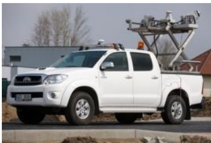
Obr. 3.1: Skener umístěný na automobilu
