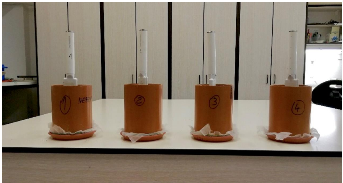
Obrázek 14 Průběh kalibrace senzoru TMS-4 (vlastní fotodokumentace).
