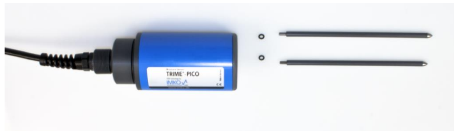
Obrázek 1 Senzor TRIME PICO 64 ( www.imko.de ).
