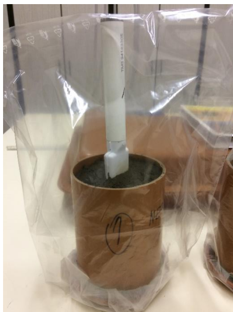
Obrázek 15 Kalibrace senzoru TMS-4, válec zakrytý igelitovým pytlíkem po dobu distribuce vody (vlastní fotodokumentace).
