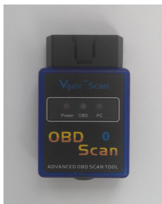
Obr. 3.2: Redukce s ELM327 a modulem Bluetooth
