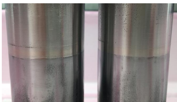
Obr. 32 Zbrošení Ni kroužku u vz. č. 19 a 20
