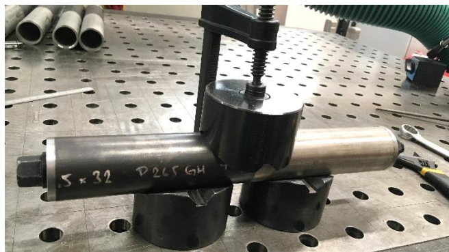
Obr. 23 Přípravek pro sestavení vzorků na ÚPT
