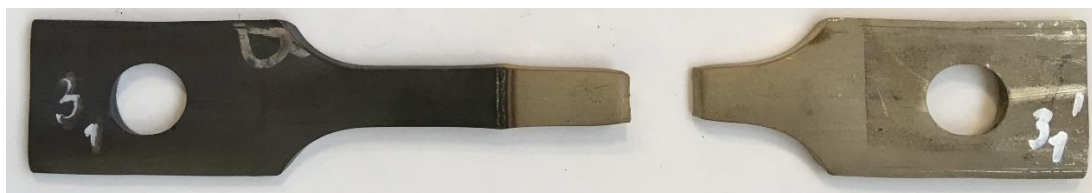
Obr. 45 Vz. č. 3 po zkoušce tahem při 350 °C
