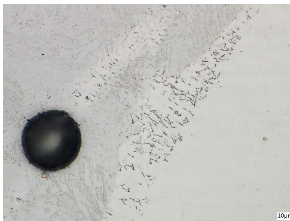
Obr. 84 Vz. 26A SK – A; \delta ferit; 1000×
