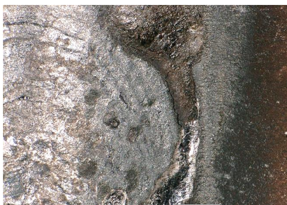
Obr. 49 Podélná trhlina, vz. č. 5; 100×
