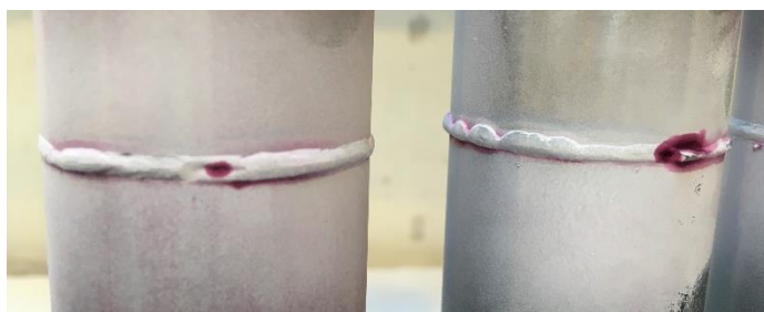
Obrázek 28 PT vzorků č. 11 (vlevo) a č. 8 (vpravo)
