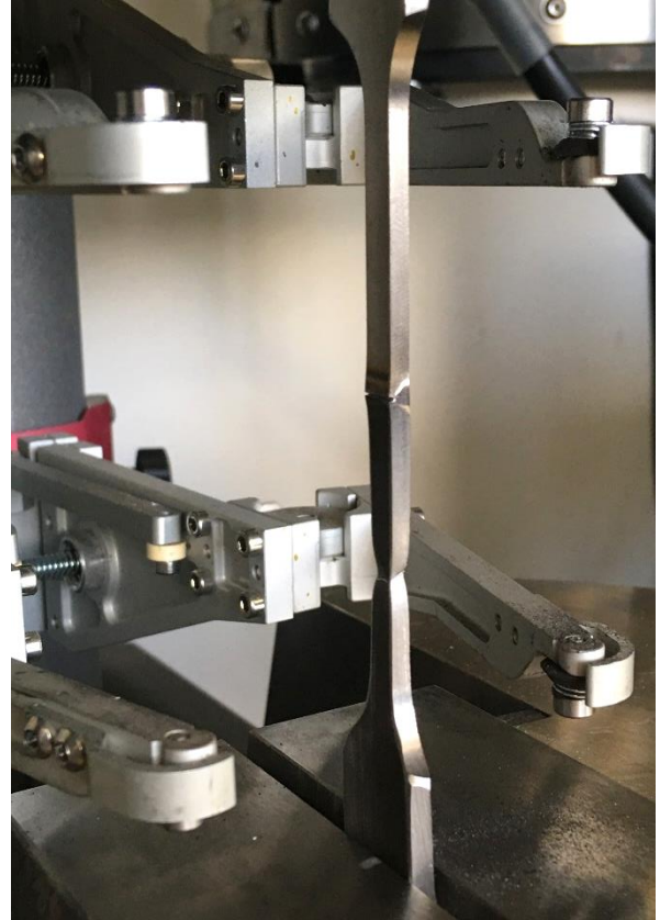
Obr. 40 Vz. č. 26 po zkoušce tahem při 20 °C
