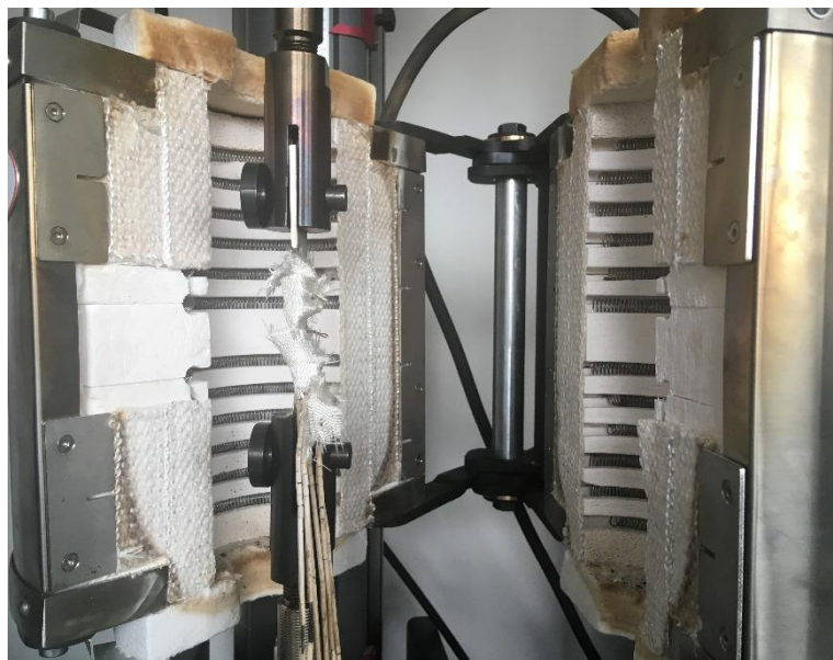
Obr. 43 Ustavování tělesa v indukční peci
