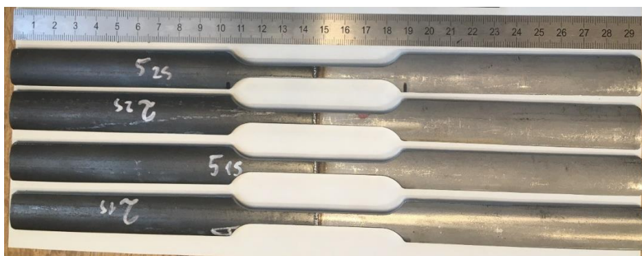
Obr. 38 Zkušební tělesa před tahovou zkouřkou za studena
