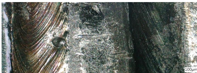
Obr. 31 Povrchový pór u vzorku č. 20
