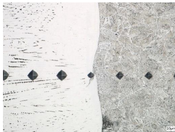
Obr. 89 Vz. 22B mikrotvrdomost;
