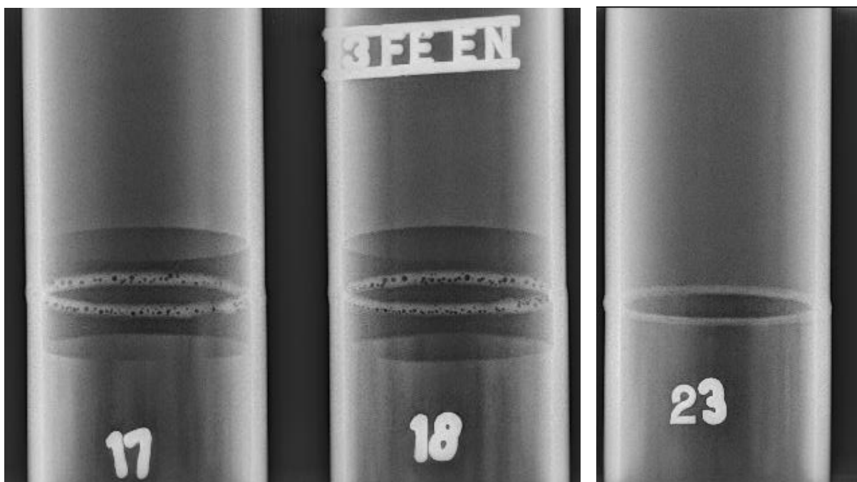
Obr. 34 Radiogramy těles č. 17 a 18, pohled A
