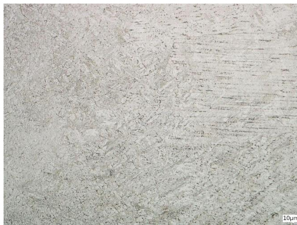
Obr. 82 Vz. 23B SK; \delta ferit kořen; 500×
