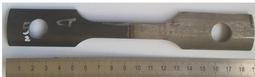
Obr. 44 Zkušební těleso pro tahovou zkoušku za zvýšené teploty
