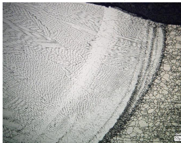
Obr. 80 Vz. 5A SK-A (krycí); 200×
