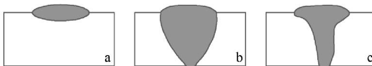
Obr. 6 Režimy laserového svařování [10]
