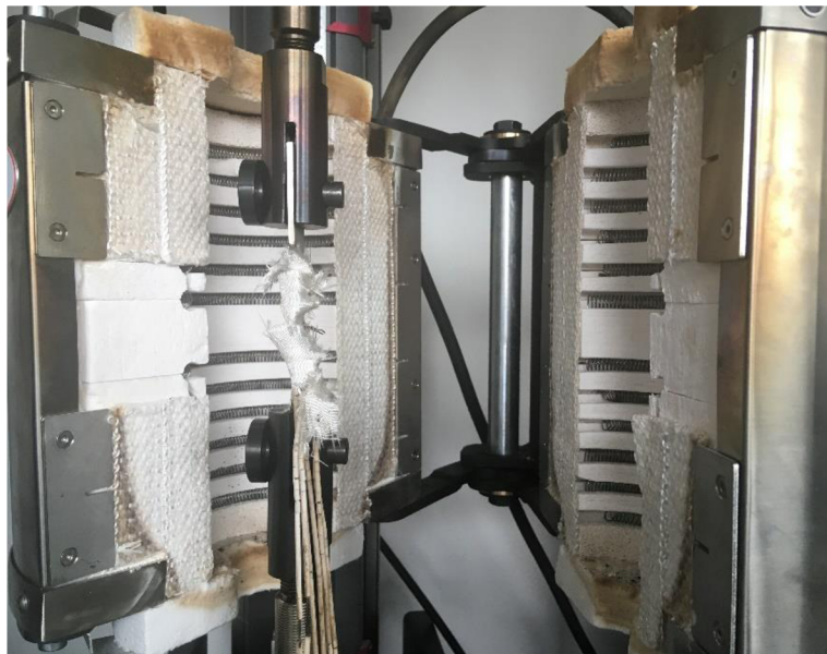
Obr. 43 Ustavování tělesa v indukční peci
