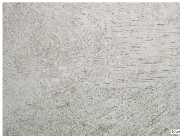
Obr. 82 Vz. 23B SK; \delta ferit kořen; 500×
