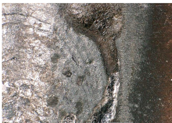
Obr. 49 Podélná trhlina, vz. č. 5; 100×
