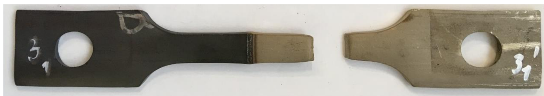
Obr. 45 Vz. č. 3 po zkoušce tahem při 350 °C
