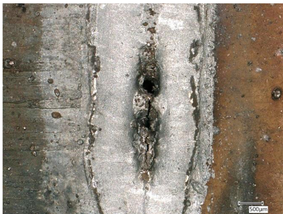
Obr. 47 Kráterová trhlina, vz. č. 6; 50×
