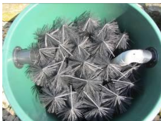
Obrázek č.20 - Prázdná kartáčová komora nádrže 2
