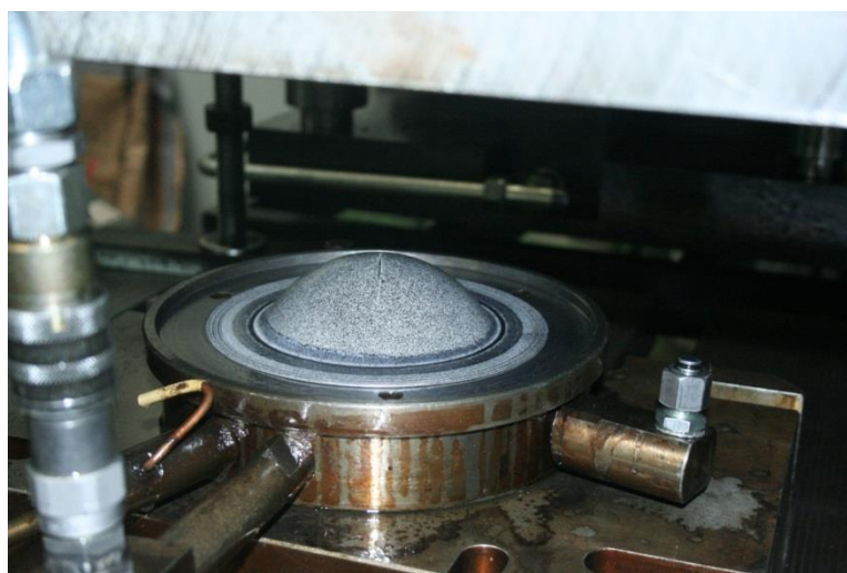
Obr. 3.13: Vzorek umístěný v nástroji po ukončení bulge testu
