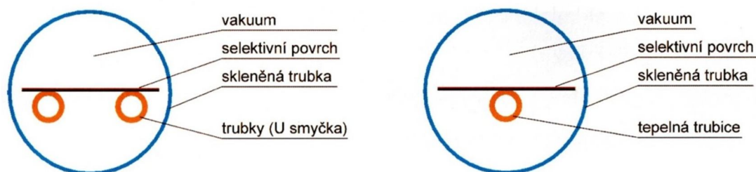
obr. 10 Jednostěnná vakuová trubka typ "Dornier" [11]
