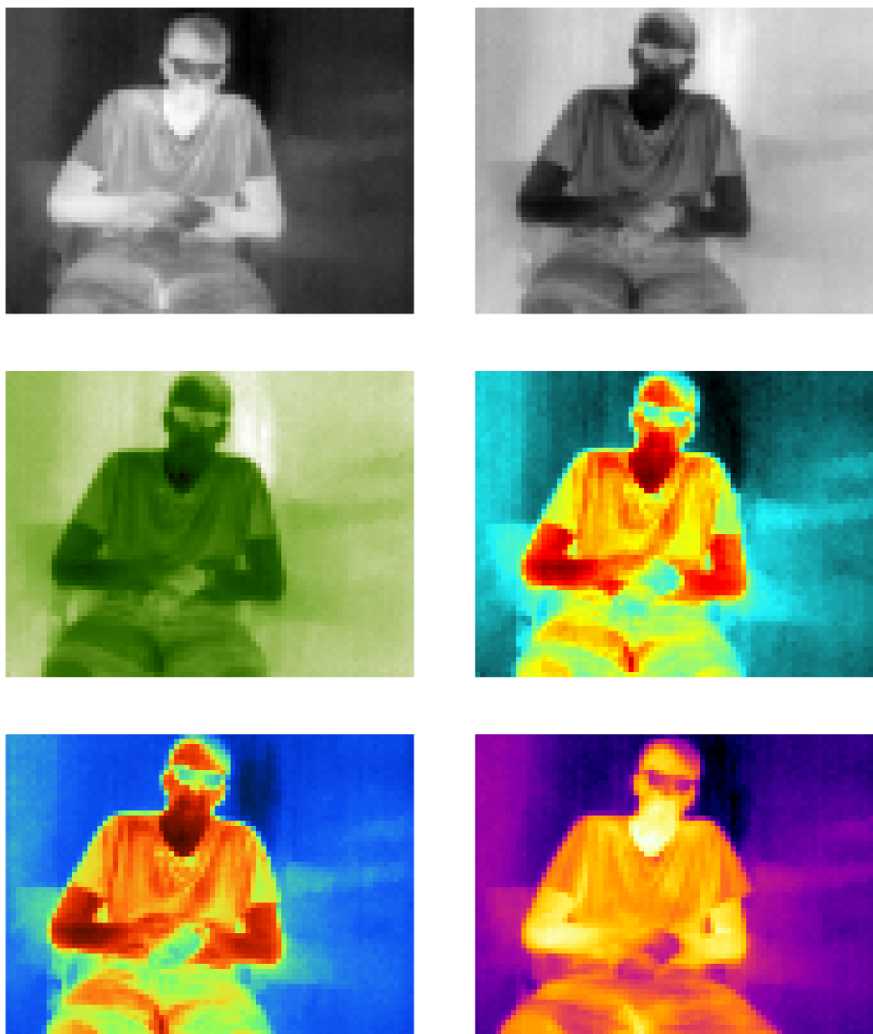
Obr. 5.4: Vygenerované palety farieb pre termogram.
