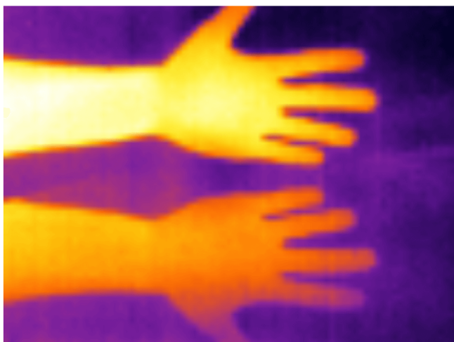
Obr. 3.1: Infračervené žiarenie ruky. V dolnej časti jeho odraz od dreveného stola.
