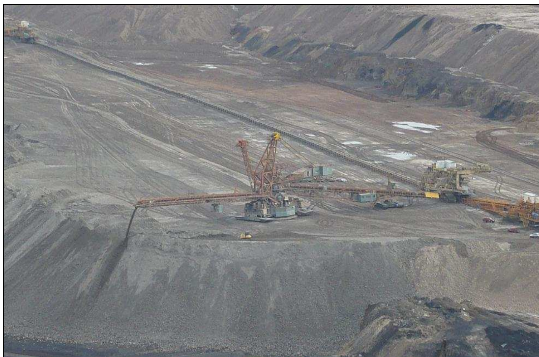
Obr. č. 12: sypaní na vnitřní výsypku lomu (internetový zdroj 7)
