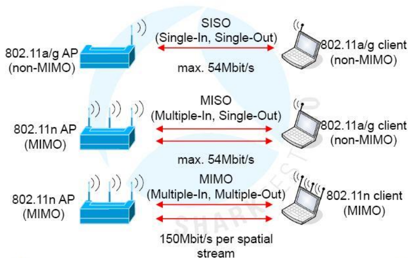
Obrázek 2 – MIMO technologie u Wi-Fi, zdroj: http://2.bp.blogspot.com/-YWIUjtCCuGY/UBst1DgYahI/AAAAAAAAAc0/TXDOKRZovL0/s1600/MIMO_1.JPG
