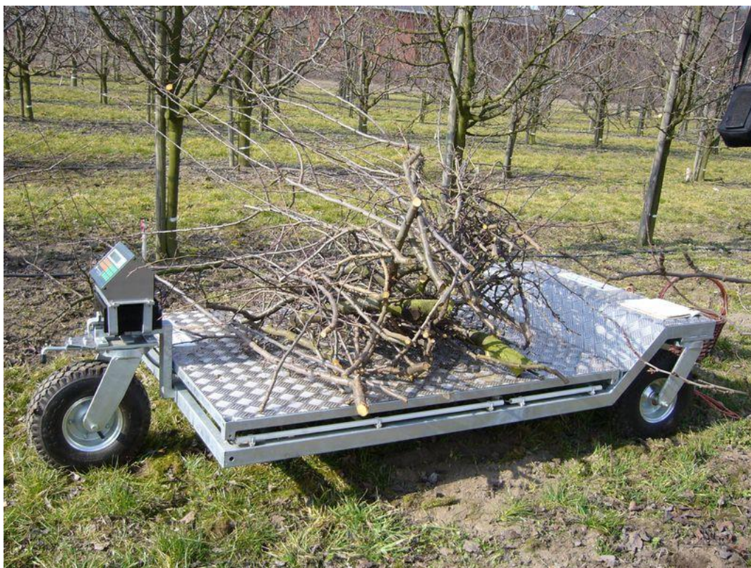
Obrázek č. 17: Vážení odřezané dřevní biomasy na pojízdné plošině s váhou
