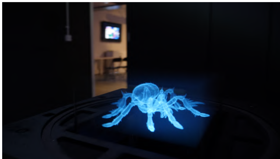
Obr. 2.3: Volumetrický displej Voxon detailne zobrazujúci pavúka 4 .
